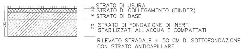
Fig. 3 - Pavimentazione stradale
