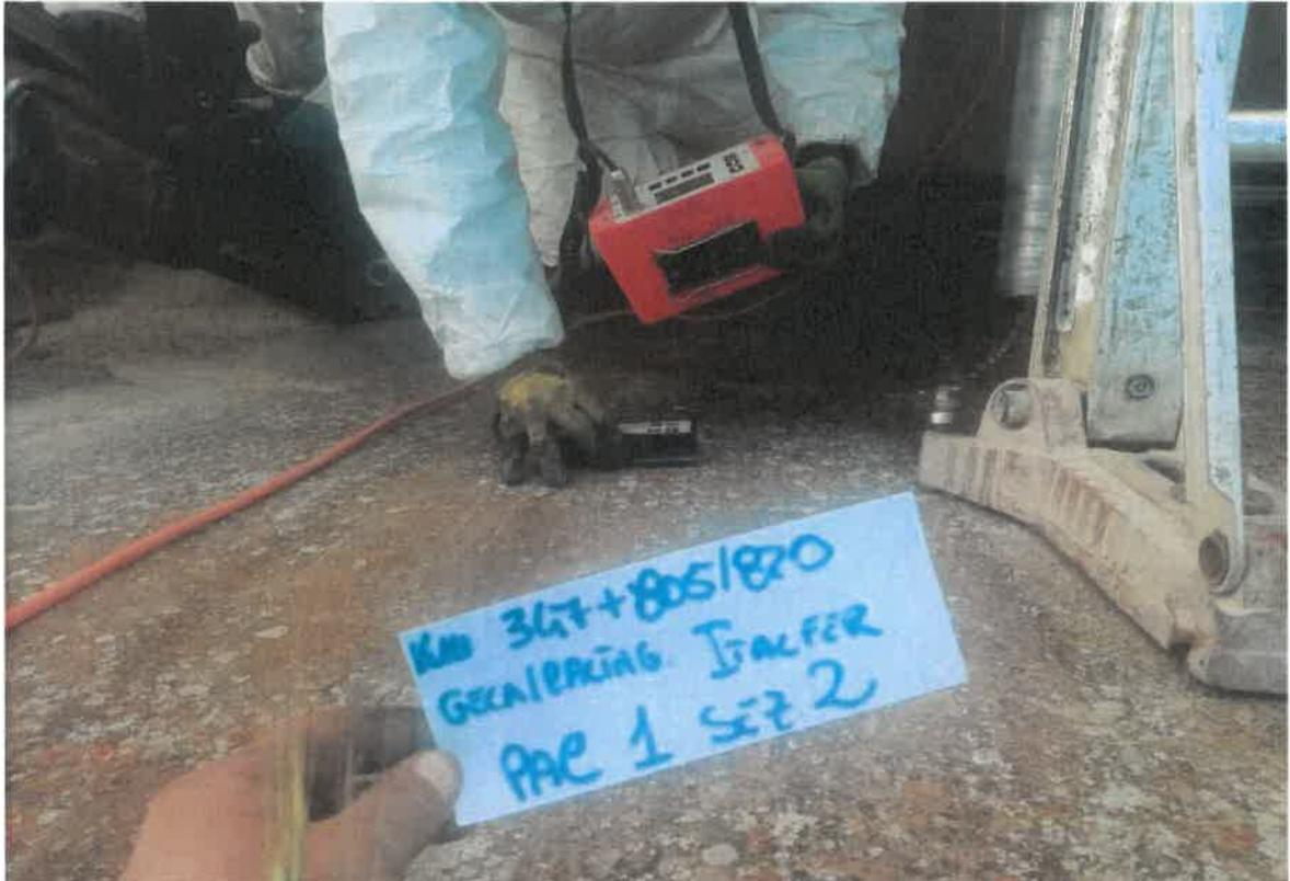
Foto 10 - Prova sclerometrica SC1 sez,1
