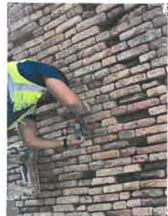
Si è inserito quindi uno speciale martinetto piatto che, collegato ad un circuito idraulico [fig. A.3.g.a], ha permesso di applicare gradualmente le pressioni che annullano la deformazione innescata dal taglio. [fig. A.3.g.b - Esecuzione del taglio, inserimento del martinetto, misura degli spostamenti].
