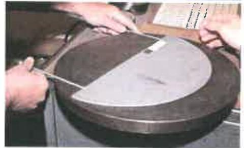
L'applicazione graduale della pressione al martinetto inserito nel taglio annullerà la convergenza in precedenza misurata e, a meno di fattori di correzione, il valore della pressione corrisponderà all'entità dello stato tensionale.
