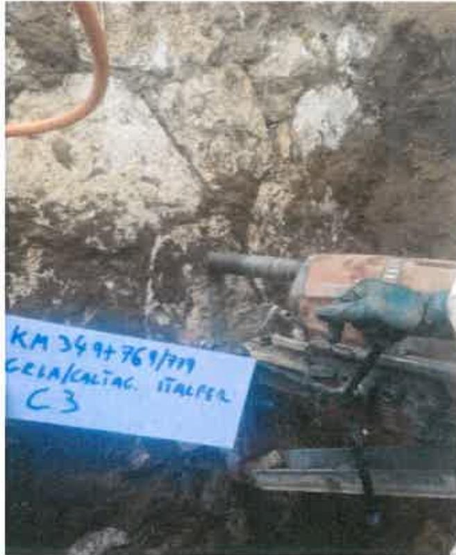
Foto 6 - Estrazione microcarota MC1 dx
