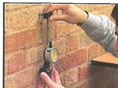
(nella prova a doppio), esso viene utilizzato per la rilevazione delle misure di convergenza a cavallo dei tagli in cui vengono introdotti i martinetti. È costituito da una barra in invar alle cui estremità sono montate due testine munite di punte coniche. Una delle testine è fissa, mentre l'altra è libera di effettuare una certa rotazione attorno ad uno speciale coltello.
