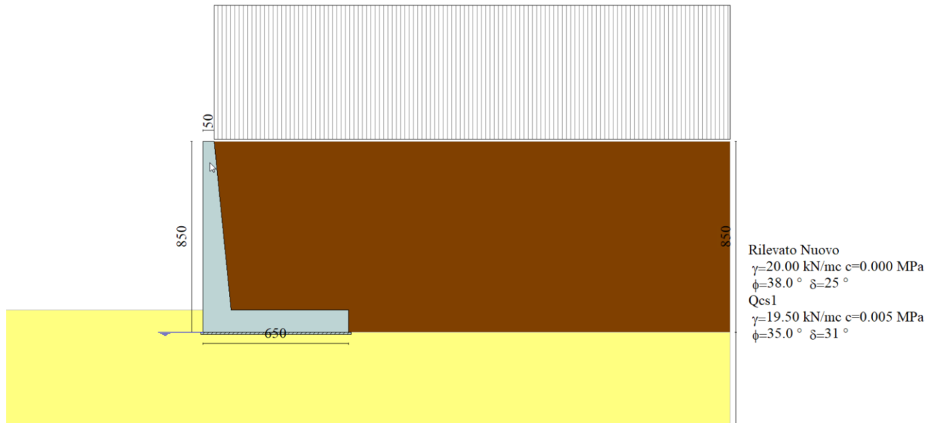
Figura 8-1 Modello di calcolo Sezione tipologica 1 - Muro a L
