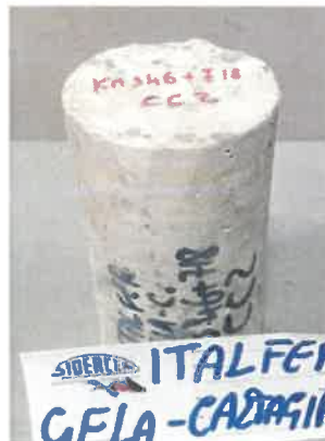
Foto 1- Misurazione carota CC2
