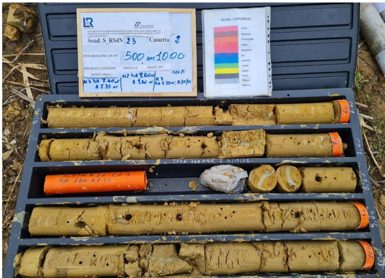
Figura 4 – Documentazione fotografica cassetta catalogatrice da 5.0 a 10.0 m (unità Qcs1a)
