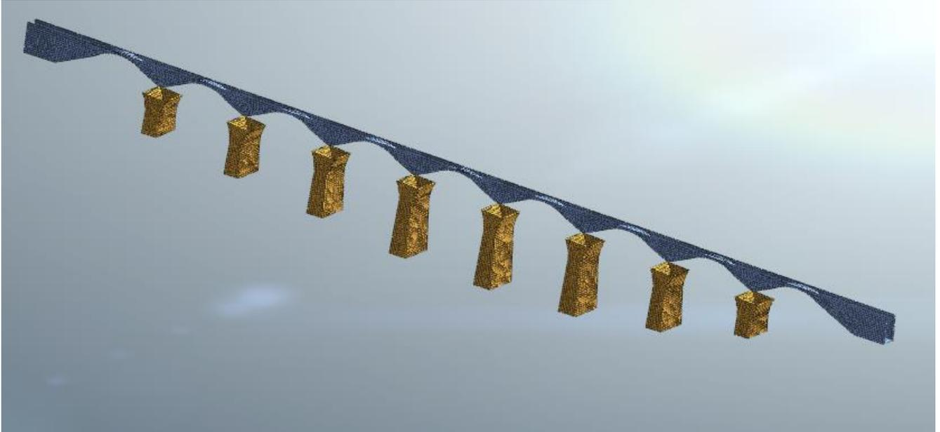
**Figura 8: Strutture di rinforzo (camicia esterna pile e interna archi)**
