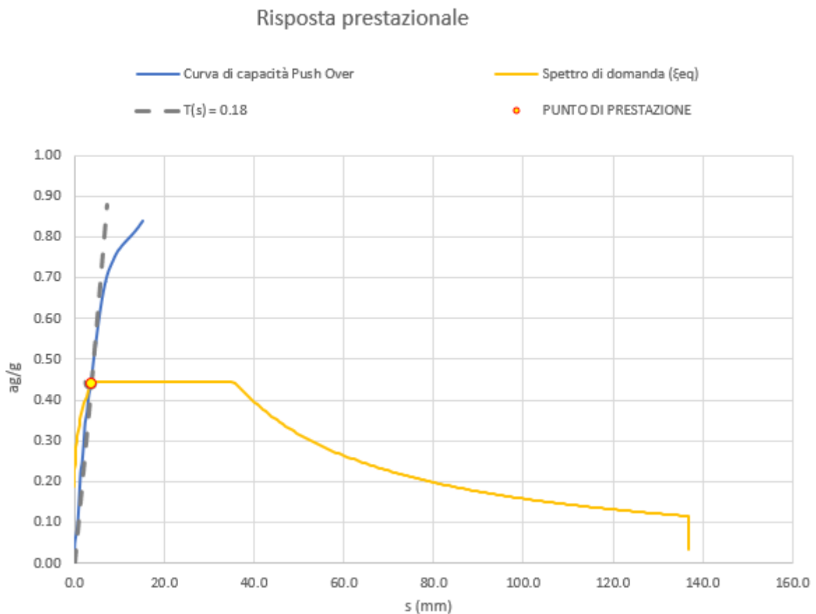
Figura 27: Verifica Domanda vs Capacità sul piano spettrale pseudo accelerazioni – pseudo spostamenti.
