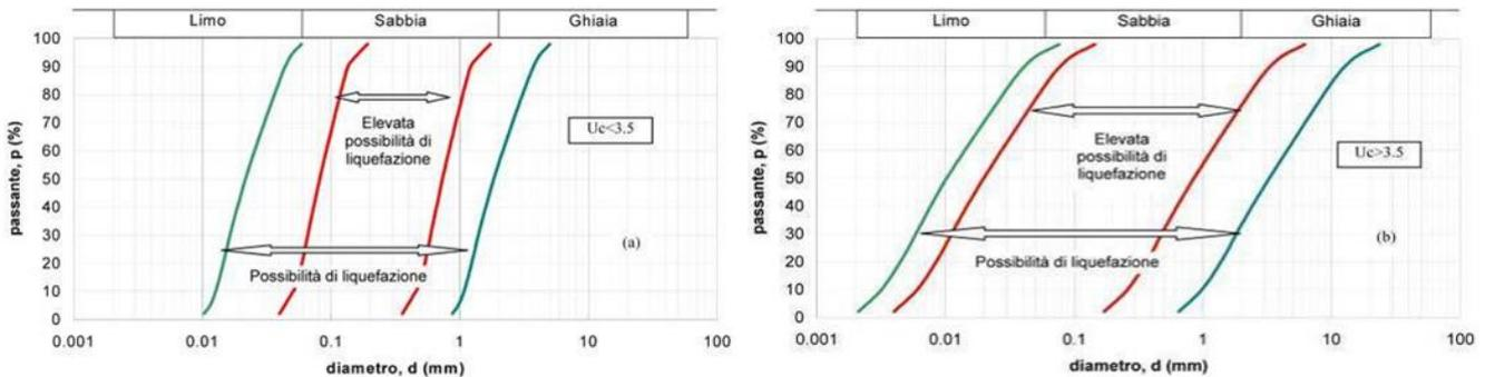
**Fig. 7: Fusi granulometrici di terreni suscettibili di liquefazione**
