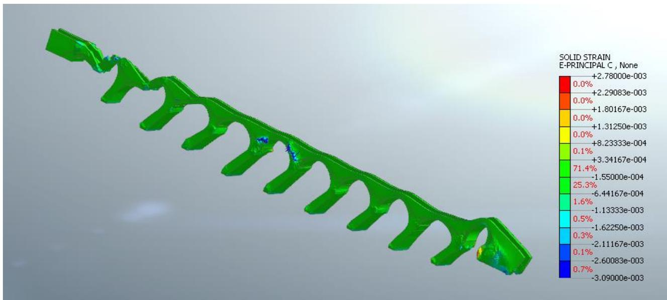
**Figura 32: Deformazione E3 (principale di compressione) allo step di collasso**
