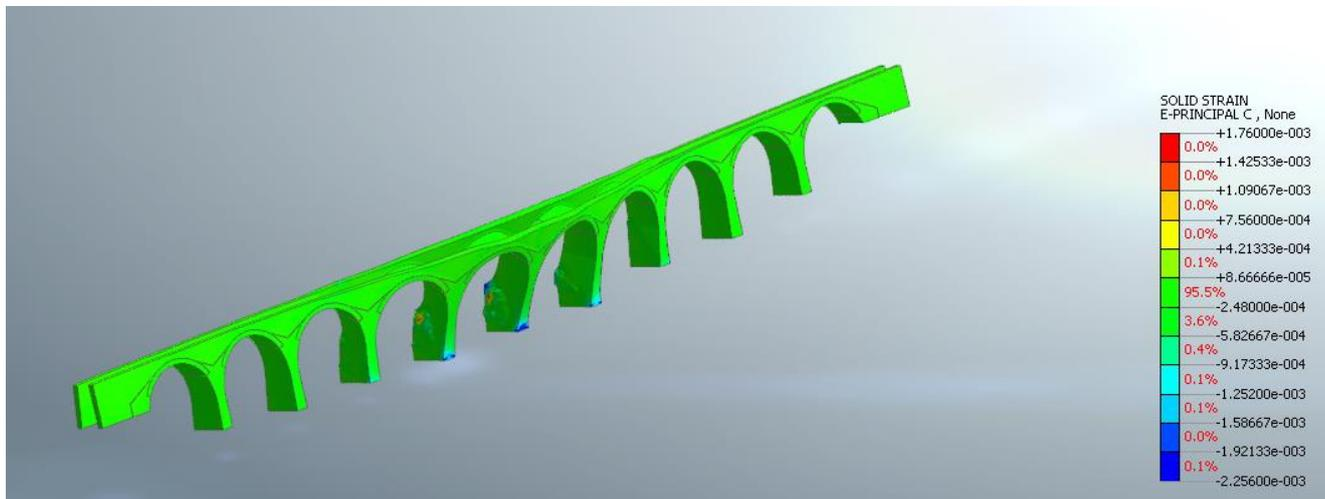
**Figura 38: Deformazione E3 (principale di compressione) allo step di collasso**
