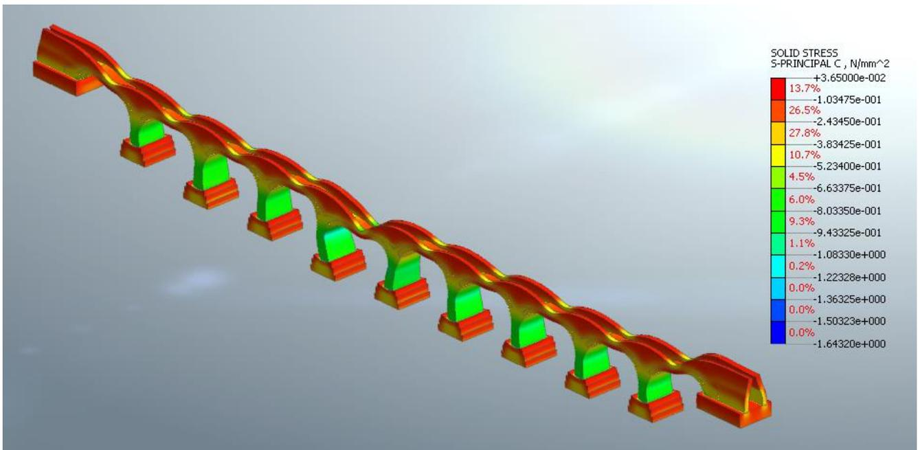
**Figura 18: tensioni massime di compressione (moltiplicatore del carico pari a 1)**
