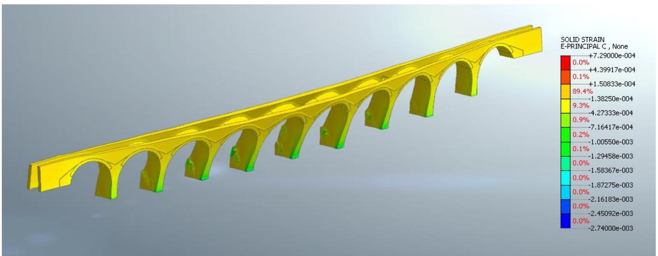
**Figura 44: Deformazione E3 (principale di compressione) allo step di collasso**
