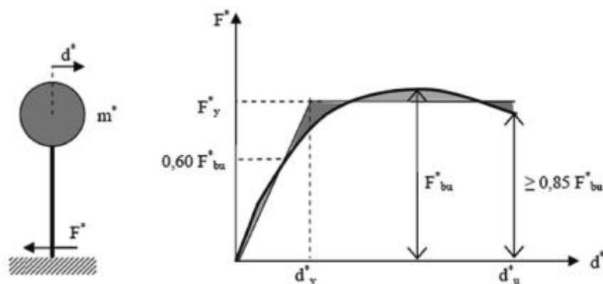
Figura C7.3.1 – Sistema e diagramma bilineare equivalente.
