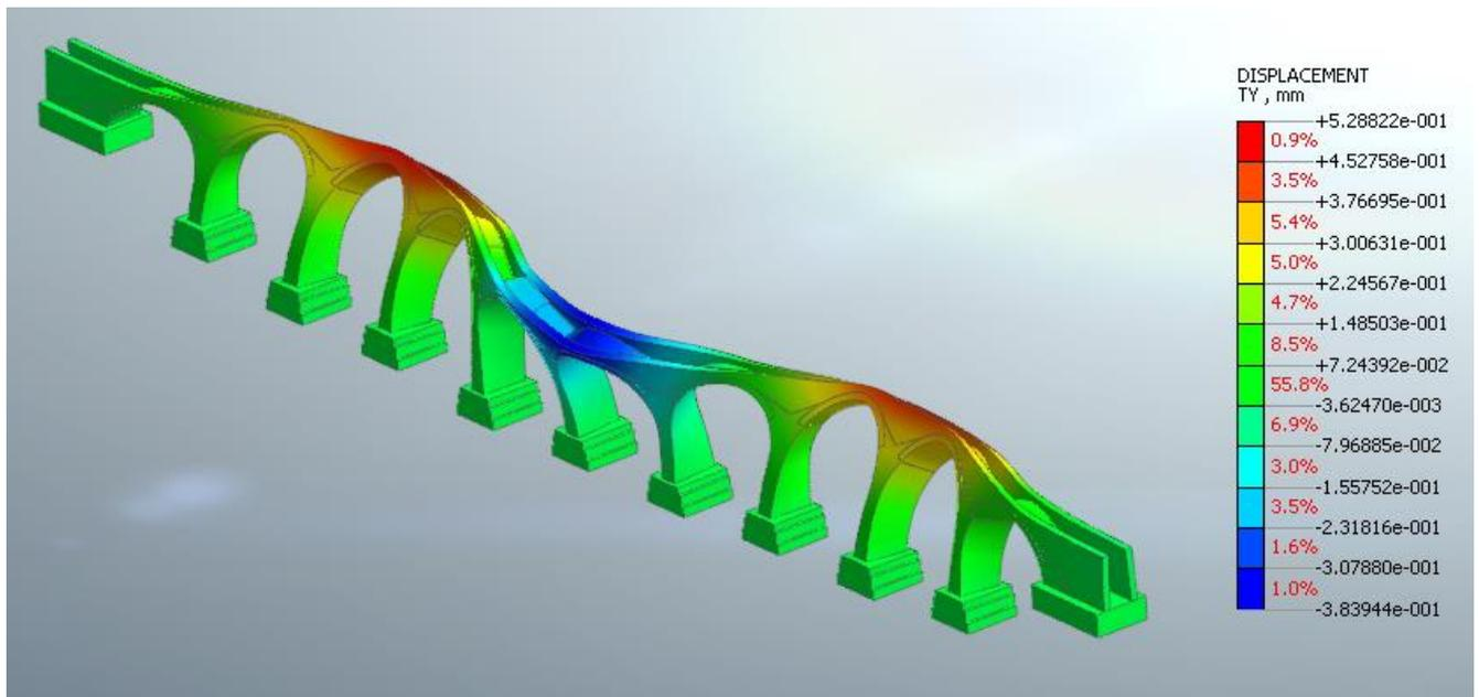
**Figura 21: 3° Modo di vibrare - secondo modo in direzione trasversale**
