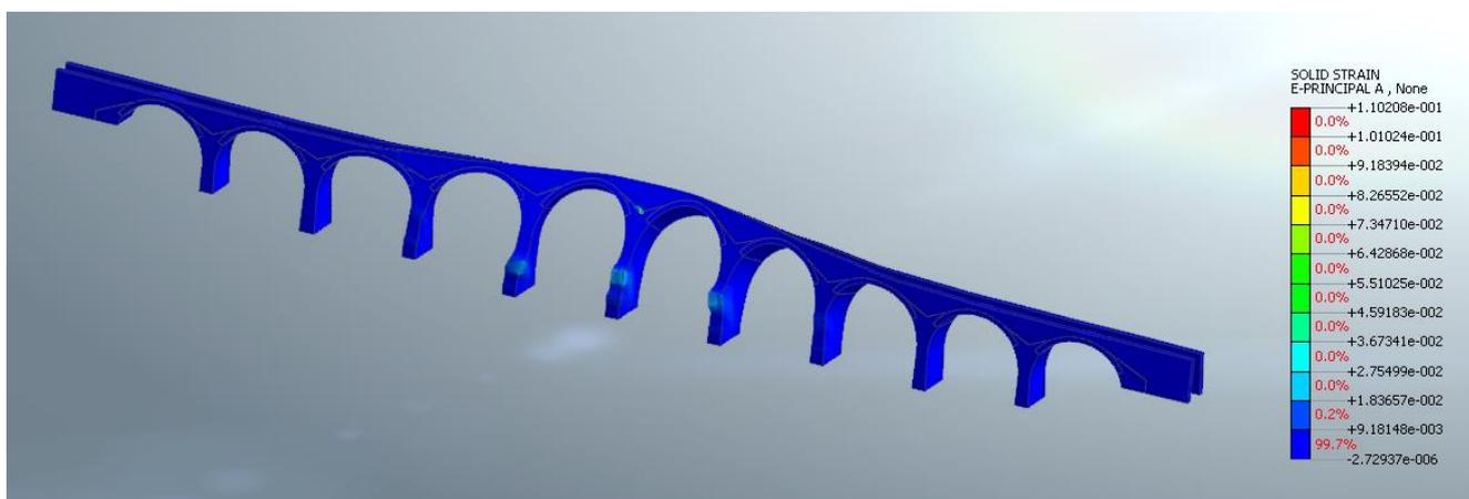
**Figura 37: Deformazione E1 (principale di Trazione) allo step di collasso**
