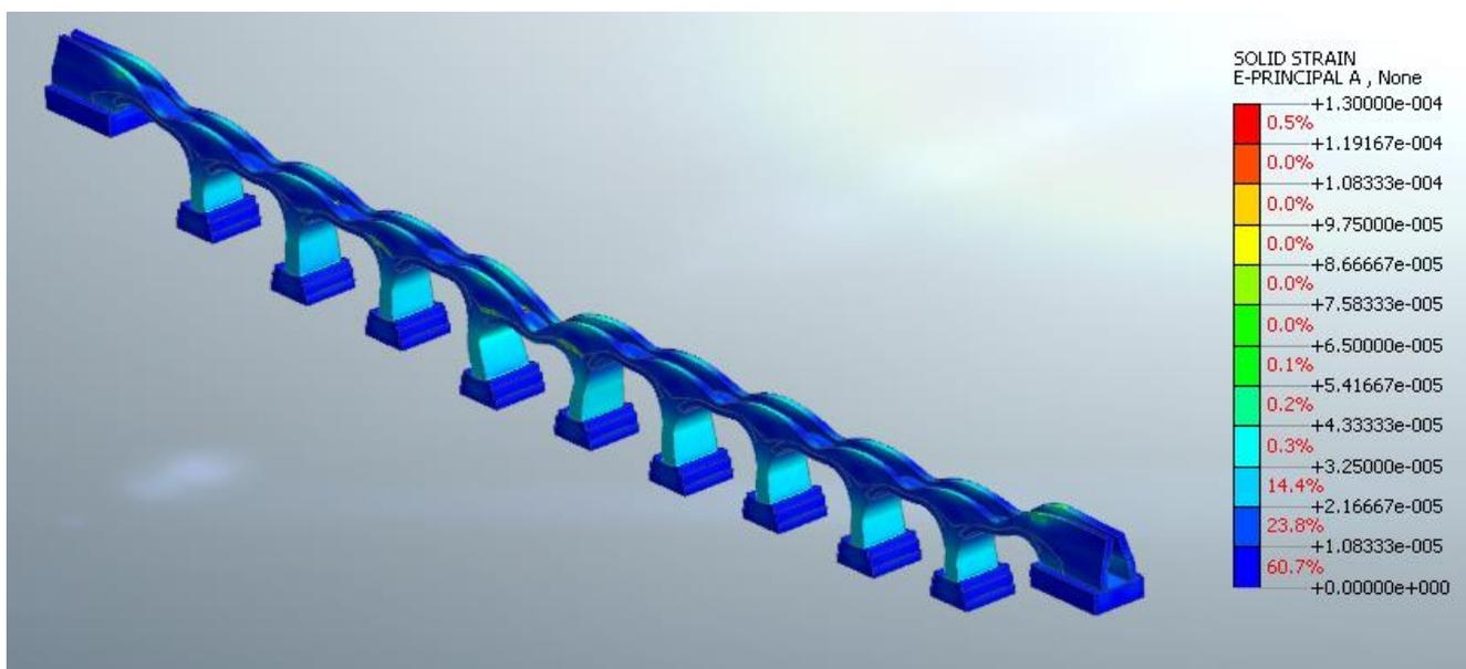
**Figura 14: deformazioni massime di trazione (moltiplicatore del carico pari a 1)**
