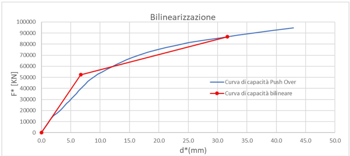
**Figura 33: Bilinearizzazione curva di capacità 1GL.**
