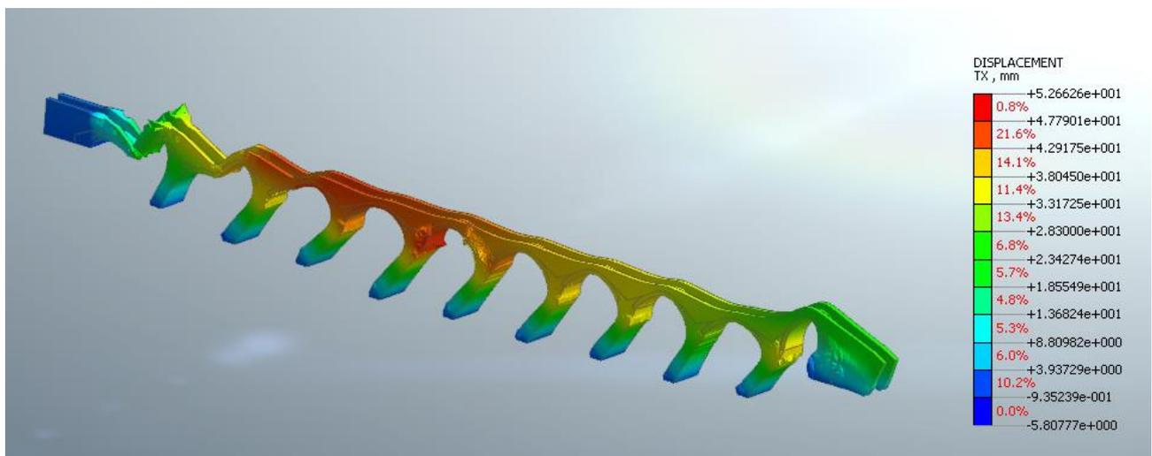
**Figura 30: Mappa cromatica spostamento DX step di collasso**
