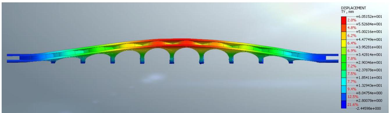
**Figura 42: Deformata allo step di collasso**
