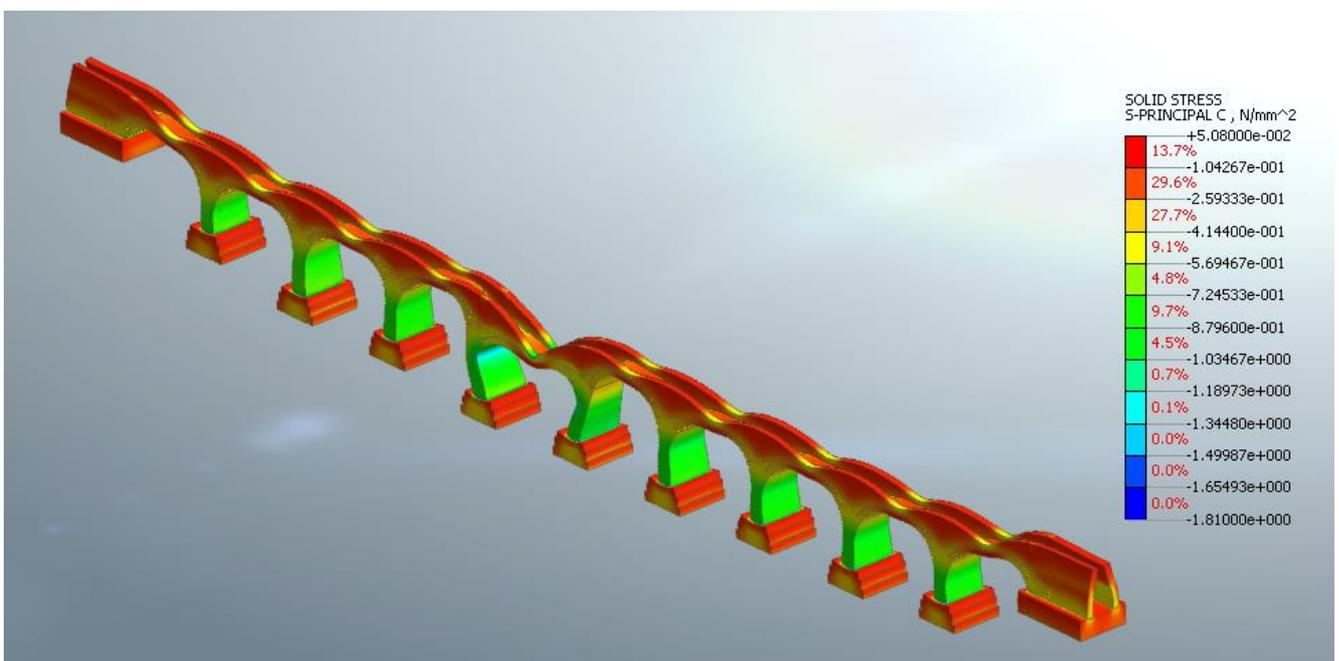
**Figura 19: tensioni massime di compressione (moltiplicatore del carico pari a 2)**
