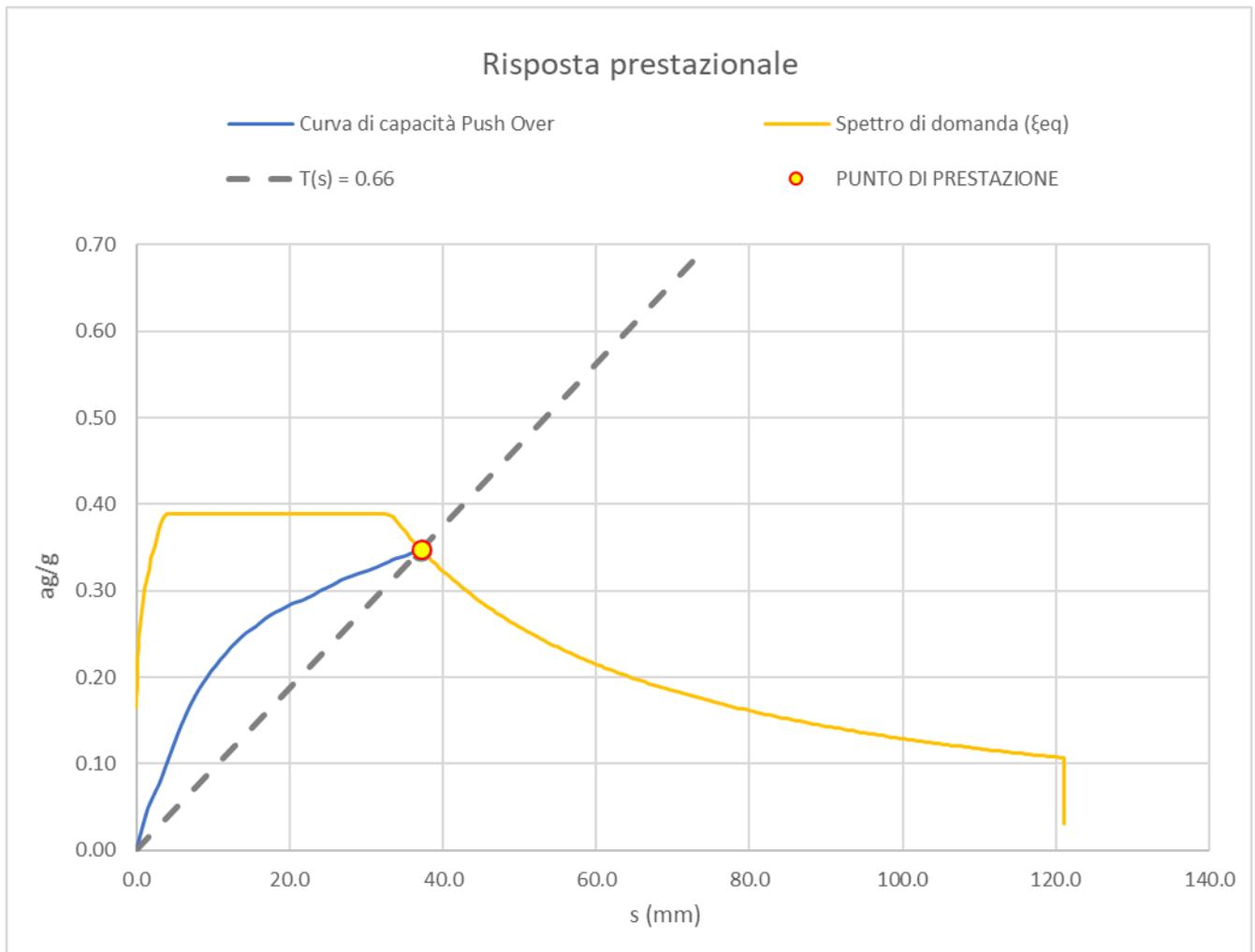
**Figura 28: Verifica Domanda vs Capacità sul piano spettrale pseudo accelerazioni – pseudo spostamenti**
