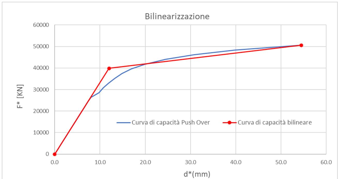
**Figura 45: Bilinearizzazione curva di capacità 1GL.**
