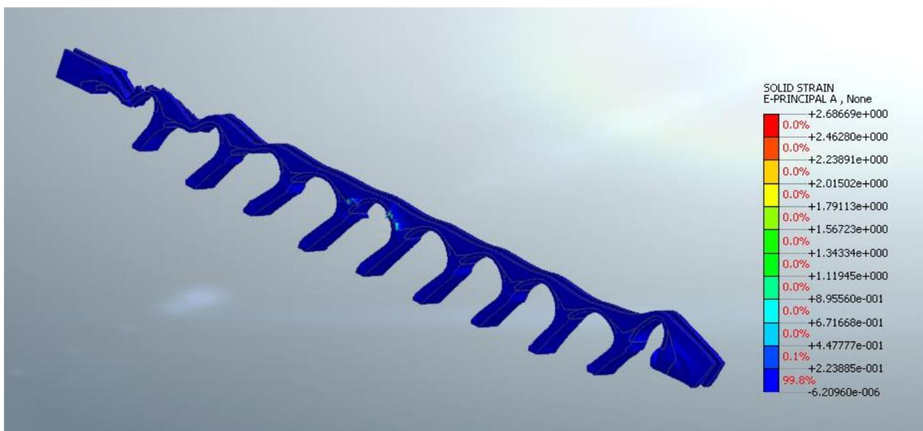
**Figura 31: Deformazione E1 (principale di trazione) allo step collasso**
