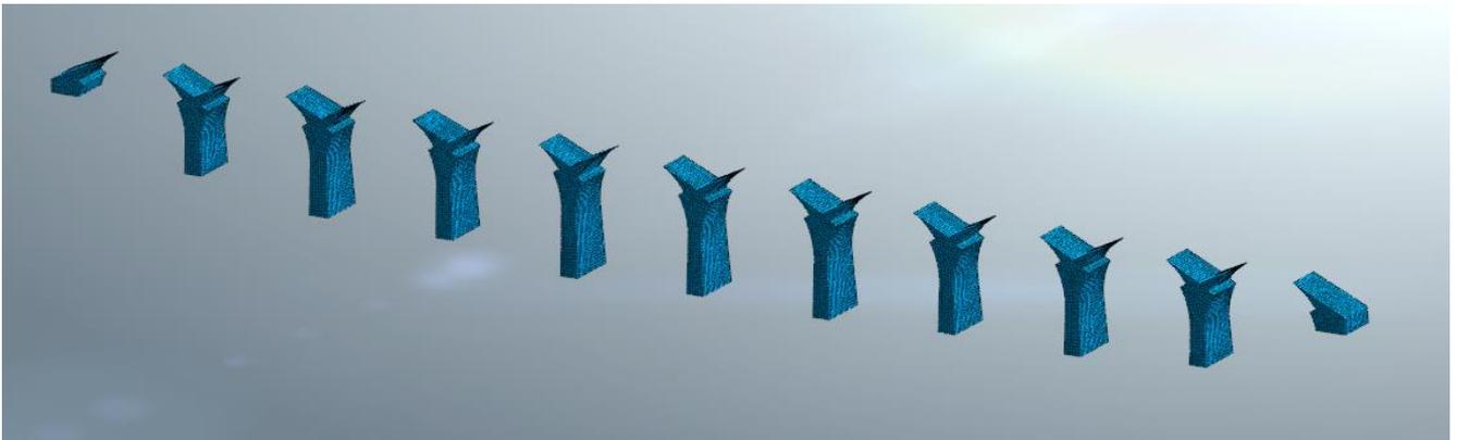
**Figura 4: Pile e Spalle**
