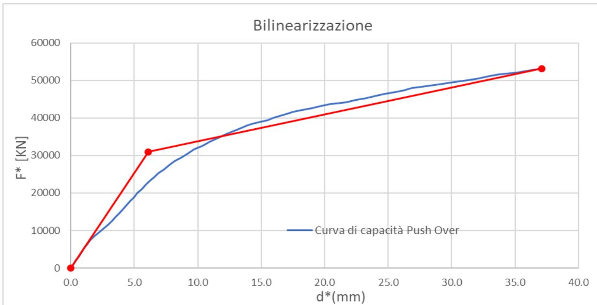
**Figura 27: Bilinearizzazione curva di capacità 1GDL.**
