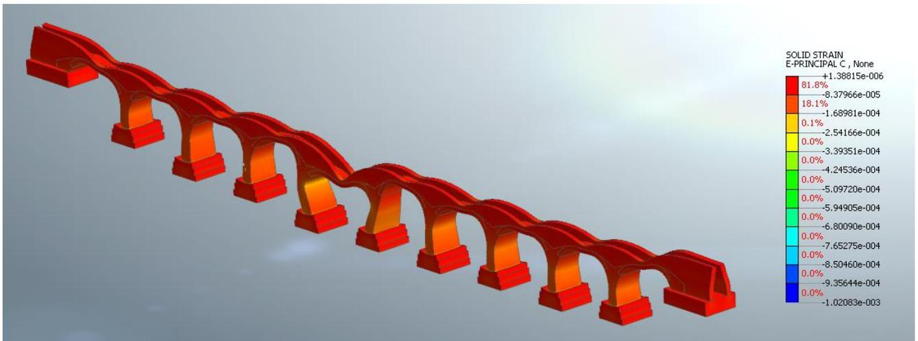
**Figura 17: deformazioni massime di compressione (moltiplicatore del carico pari a 2)**
