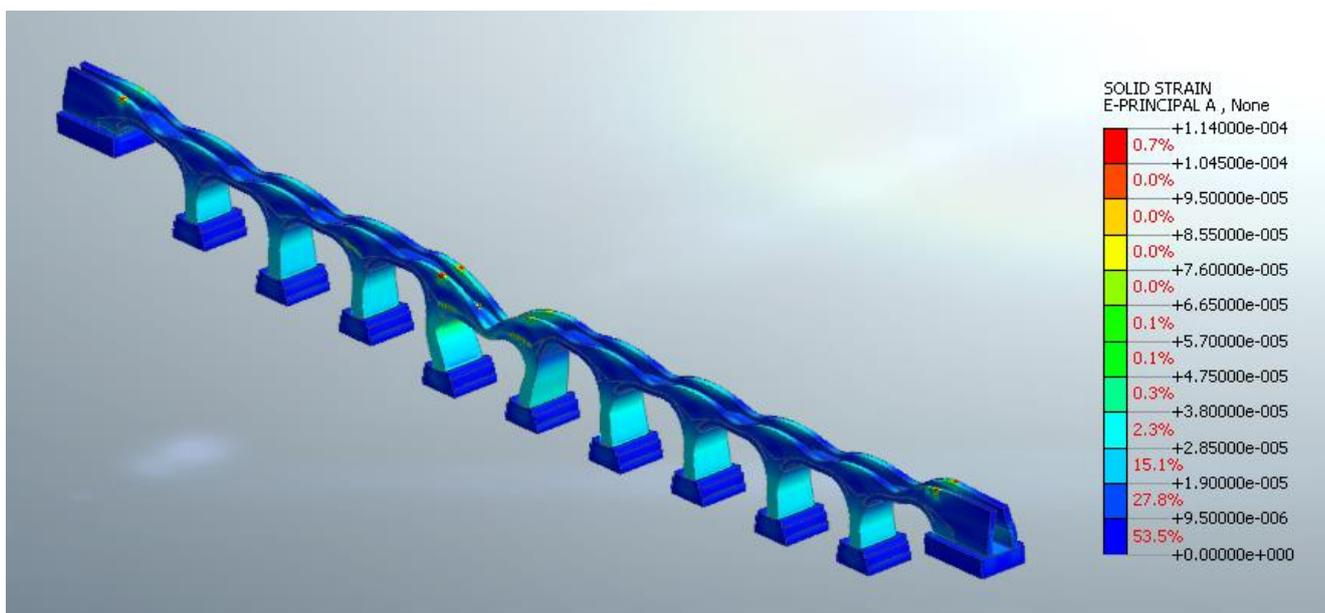
**Figura 15: deformazioni massime di trazione (moltiplicatore del carico pari a 2)**
