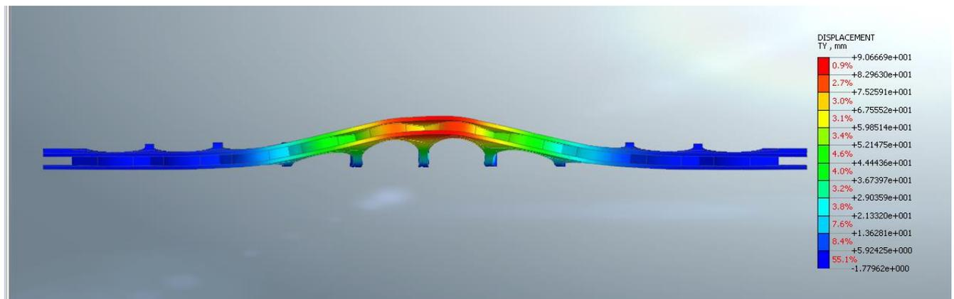
**Figura 36: Mappa cromatica spostamento DY step di collasso**
