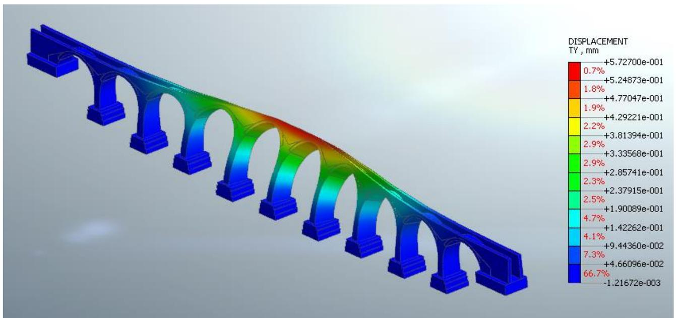
**Figura 20: 1° Modo di vibrare – modo fondamentale in direzione trasversale**
