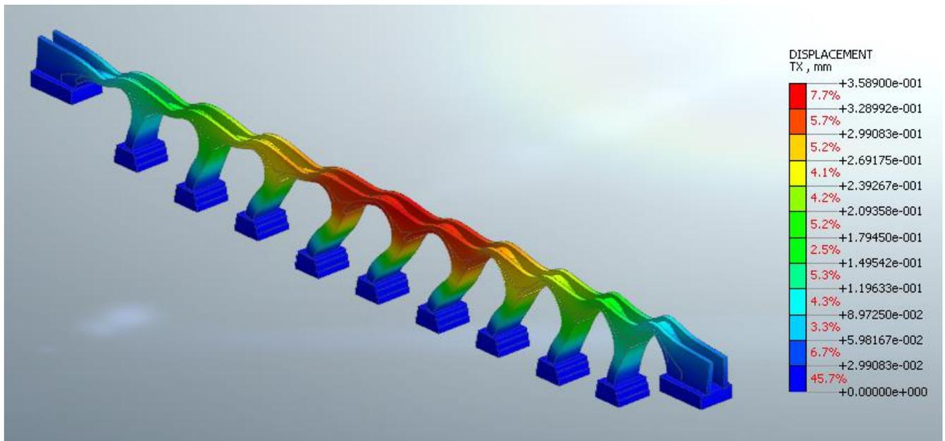
**Figura 22: 3° Modo di vibrare – modo fondamentale in direzione longitudinale**
