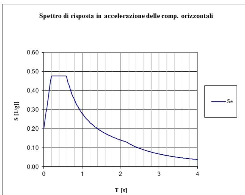
Figura 10: Spettro accelerazioni orizzontali
