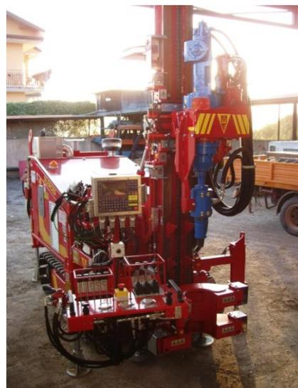
La perforazione è stata eseguita con l'ausilio di doppio carotiere TS6 in corrispondenza del litotipo di fondazione (muratura) e utilizzo di corone diamantate della Serie 8 e della Serie 6 e con carotieri semplici in corrispondenza dei litotipi sabbiosi e argillosi con utilizzo di corone al Widia serie TC5.
