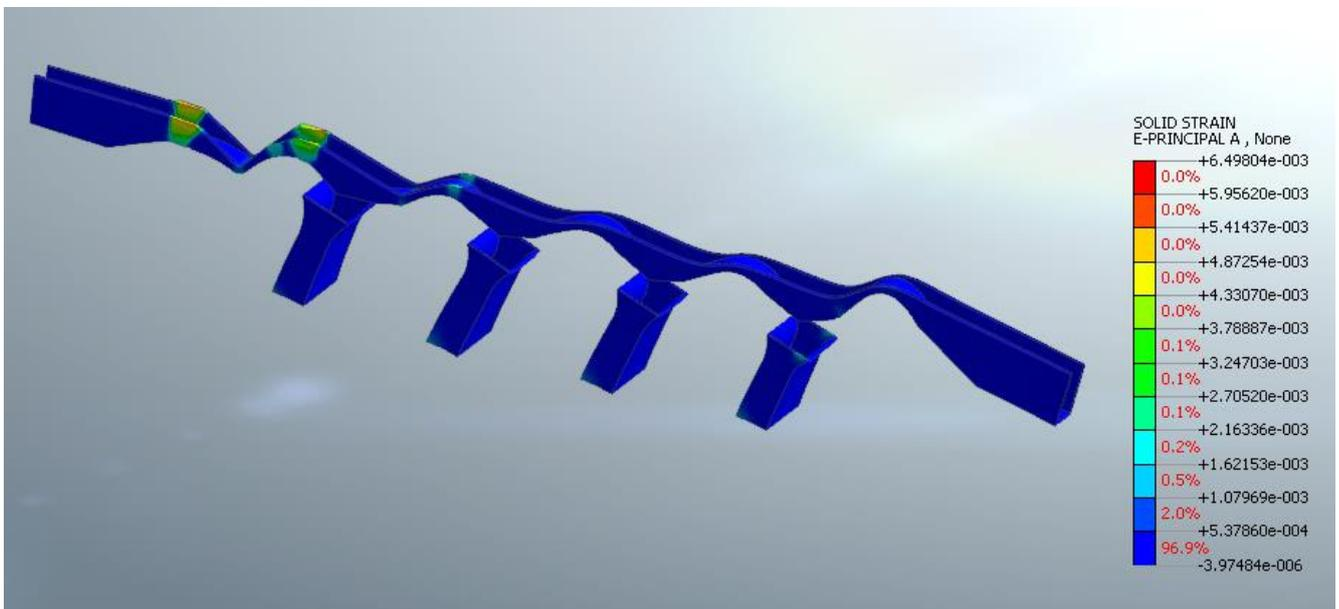
**Figura 18: Deformazione principali (compressione sopra, trazione sotto) negli elementi in c.a. di rinforzo allo step collasso**
