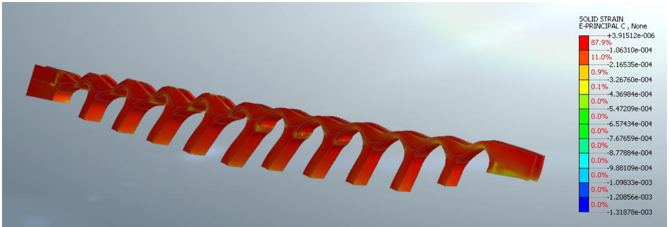
Figura 25: Deformazione E3 (principale di compressione) nella muratura allo step di collasso
