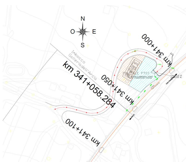
Figura 4 Piazzale emergenza imbocco Galleria dell'Arcia
