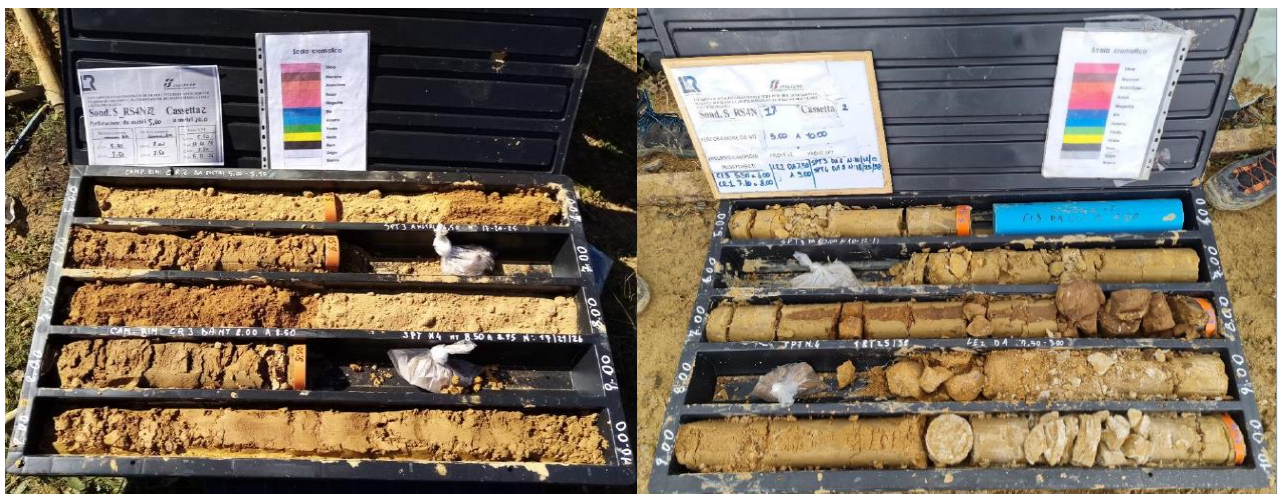
Figura 2. Sabbie limo argillose nel foro di sondaggio S_RS4N_22 tra 5 e 10 m S_RS4N_17 tra 5 e 10 m da p.c.
