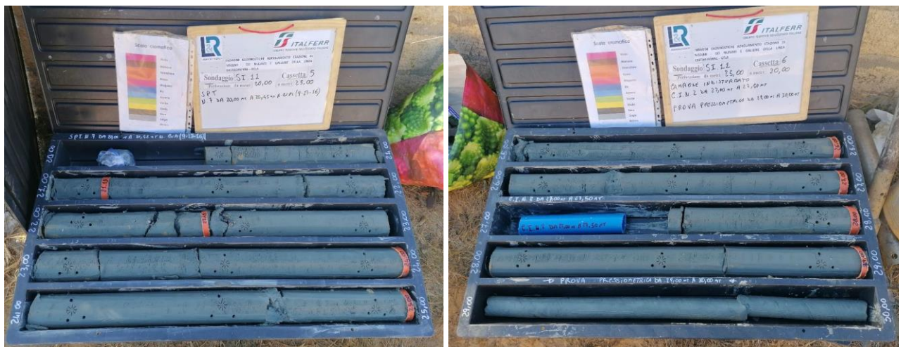
Figura 20. Argille limo sabbiose nel foro di sondaggio SI_11 tra 20 e 30 m da p.c.
