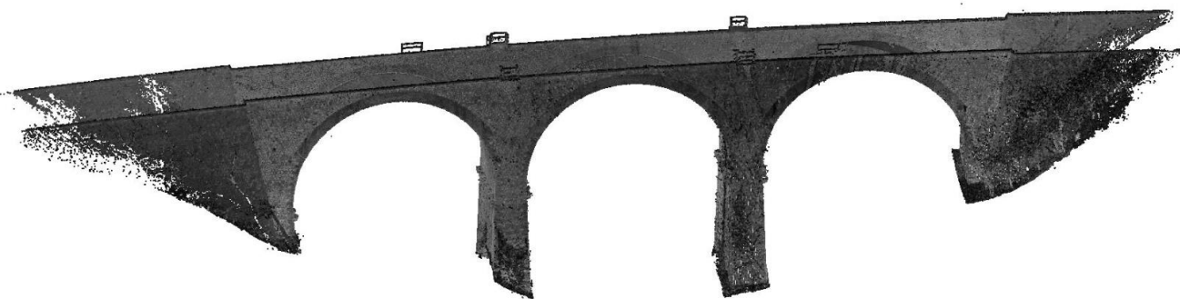
Figura 11: Restituzione laser-scanner dell'opera.
