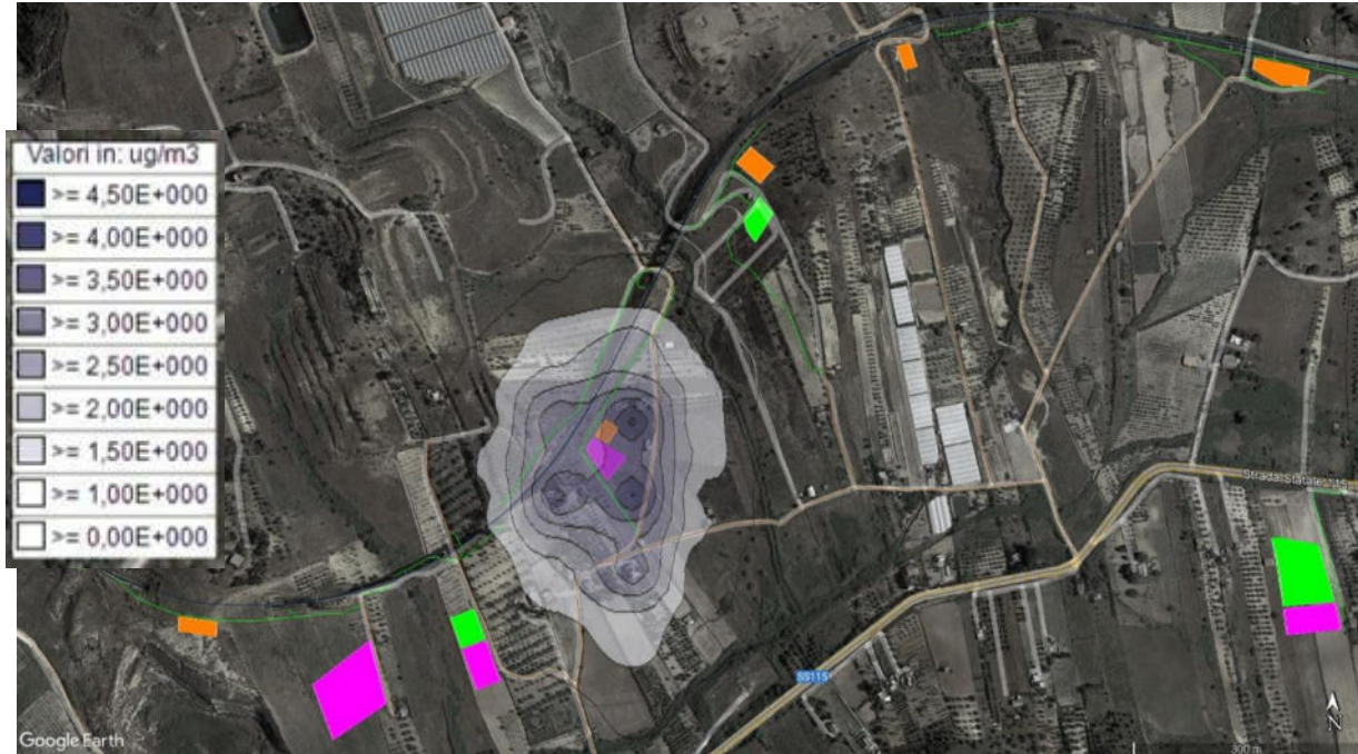
Figura 6-26 Concentrazioni di NO_x dovute alle emissioni dei mezzi d'opera per AS39 e AT76
