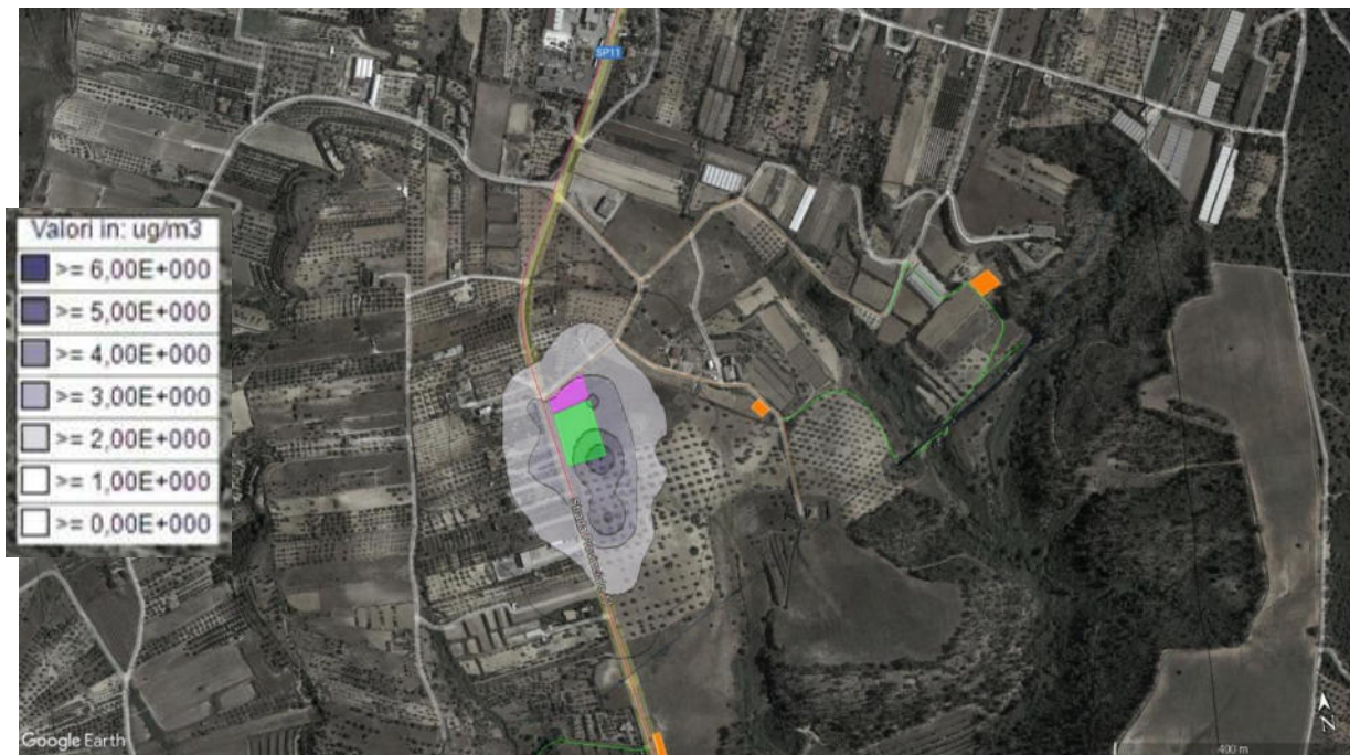
Figura 6-24 Concentrazioni di NO_x dovute alle emissioni dei mezzi d'opera per AS25 e CO04
