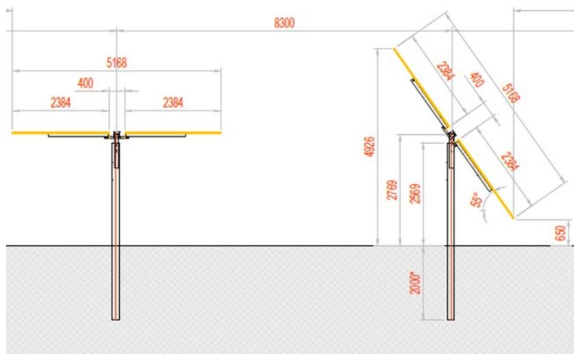
Figura 4.4: Particolare strutture di sostegno moduli
