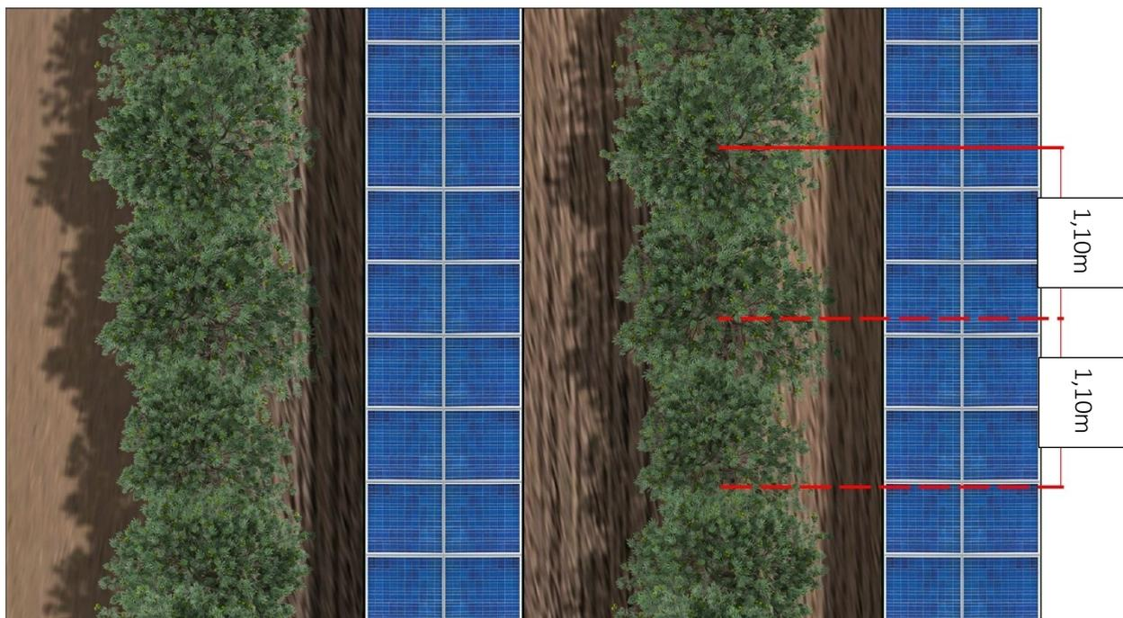
Figura 6.3: Tipologico – Vista Planimetrica dell’impianto Olivicolo.
