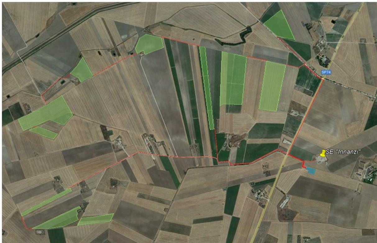
*Figura 4.8: In rosso il percorso di connessione dal campo FV alla stazione elettrica.*
