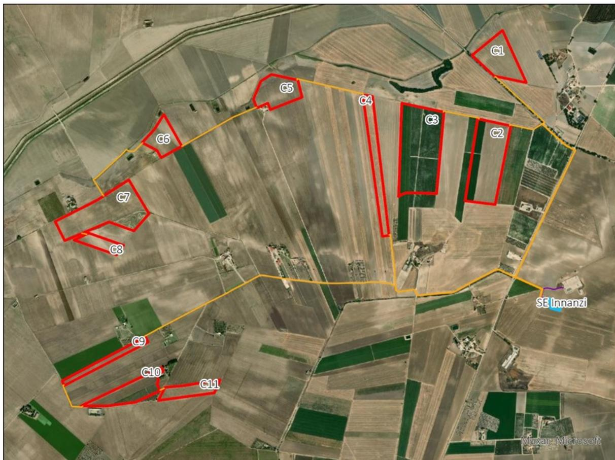
Figura 2.1: Localizzazione dell'area di intervento (ROSSO: impianto; ARANCIO: Cavidotto di Connessione di Media Tensione, AZZURO: Stazione di Trasformazione MT/AT; VIOLA: Cavidotto AT)
