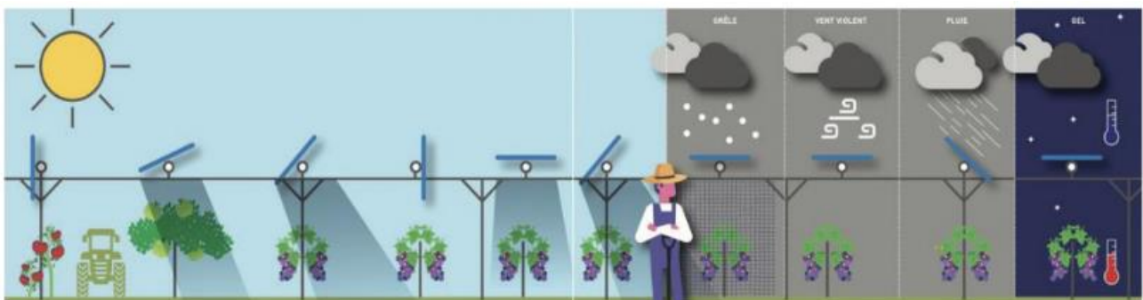
Figura 1: Illustrazione del funzionamento di un sistema agrovoltaico (Fraunfer, 2020)
