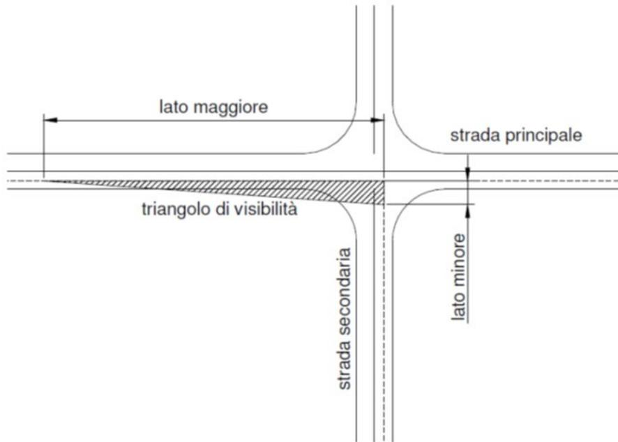
Schema di verifica dei triangoli di visibilità delle intersezioni - D.M. 19/04/2006
