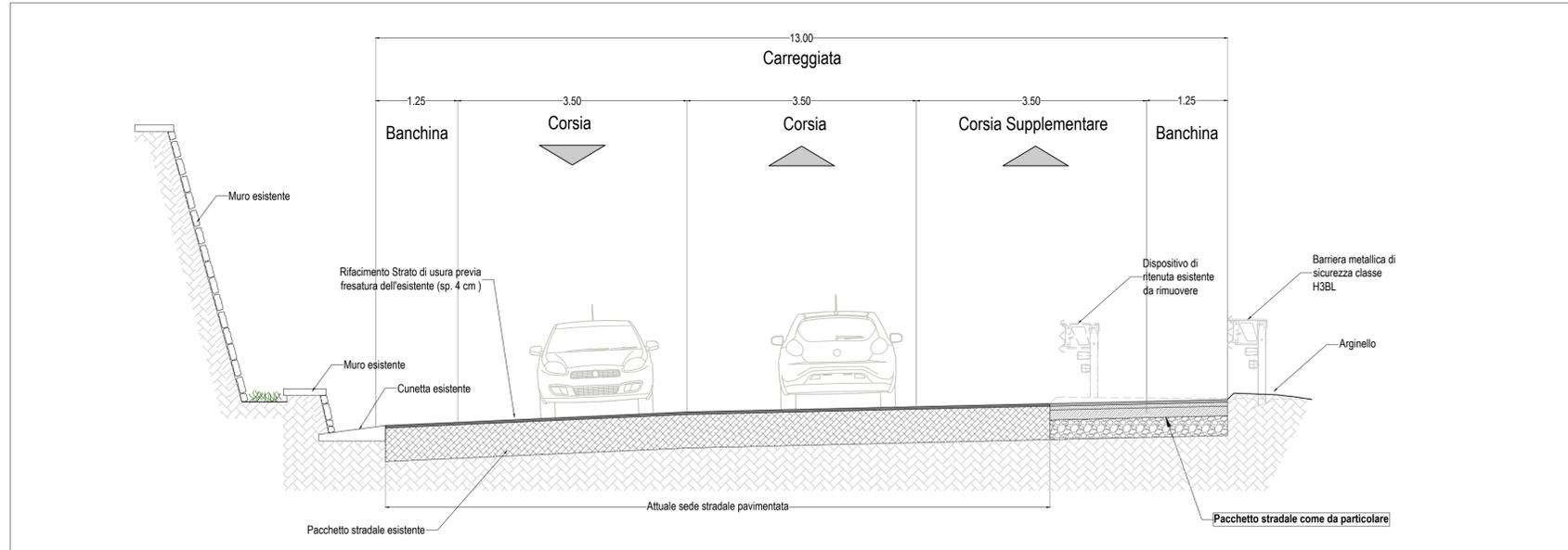
**Sezione tipo in rettilo con allargamento su struttura a sbalzo in c.a.**
