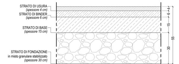
N.B. Tra i vari strati in conglomerato della sovrastruttura applicare una 'mano di attacco' di emulsione bituminosa
