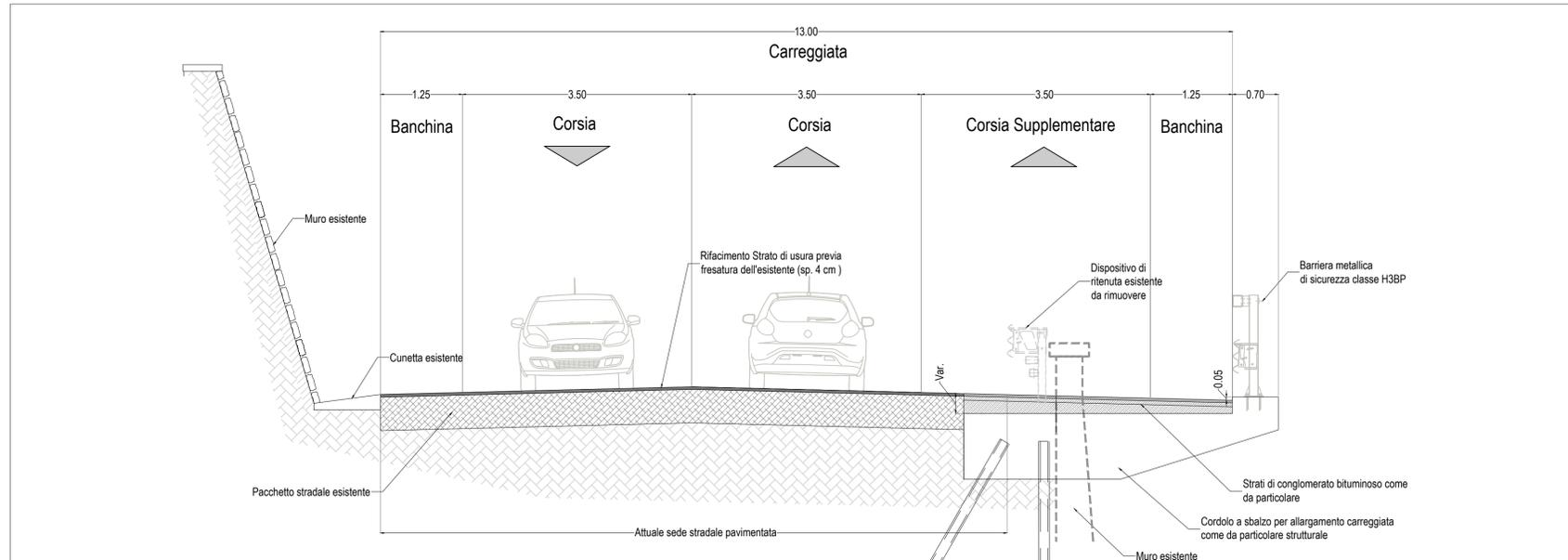
**Sezione tipo in curva con allargamento su struttura a sbalzo in c.a.**
