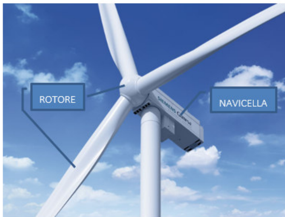
Figura 2.1: Rappresentazione di un aerogeneratore.
