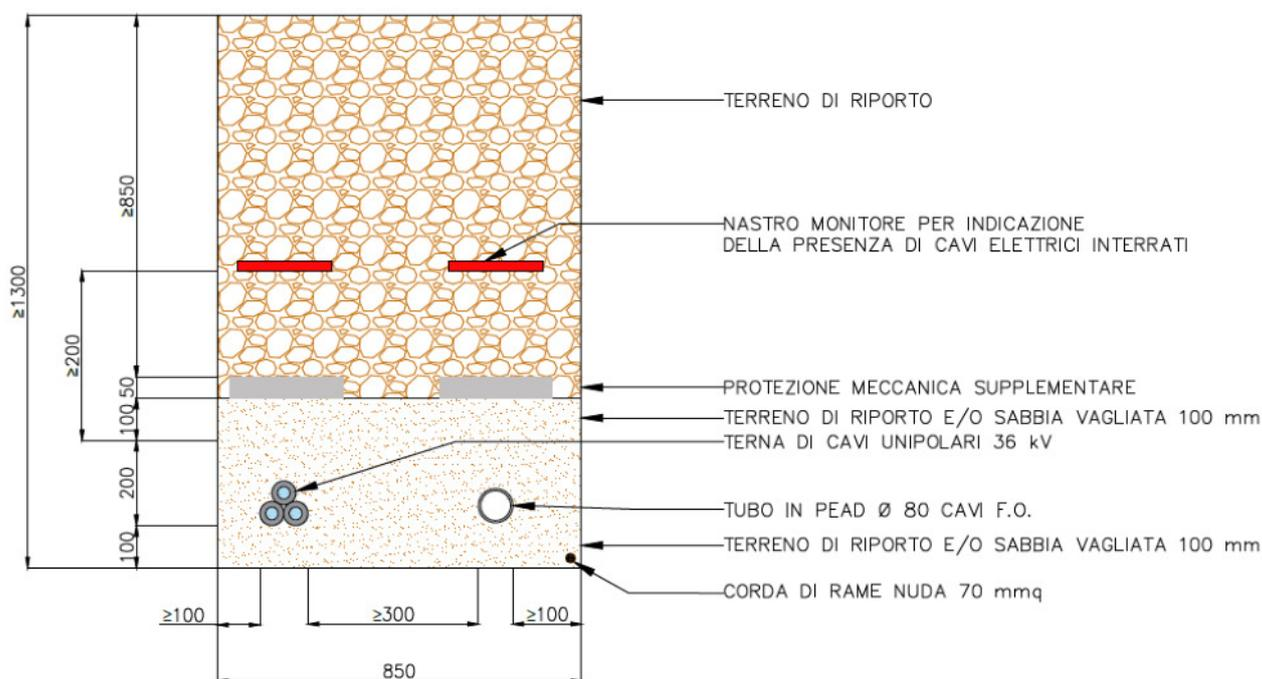
Figura 4.1: Sezione scavo tipo posa cavidotti
