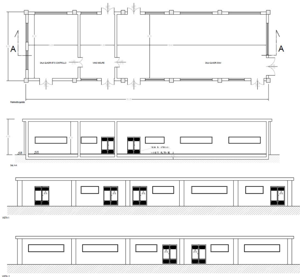
Figura 4-3: Viste in pianta, sezione e prospetto cabina di raccolta
