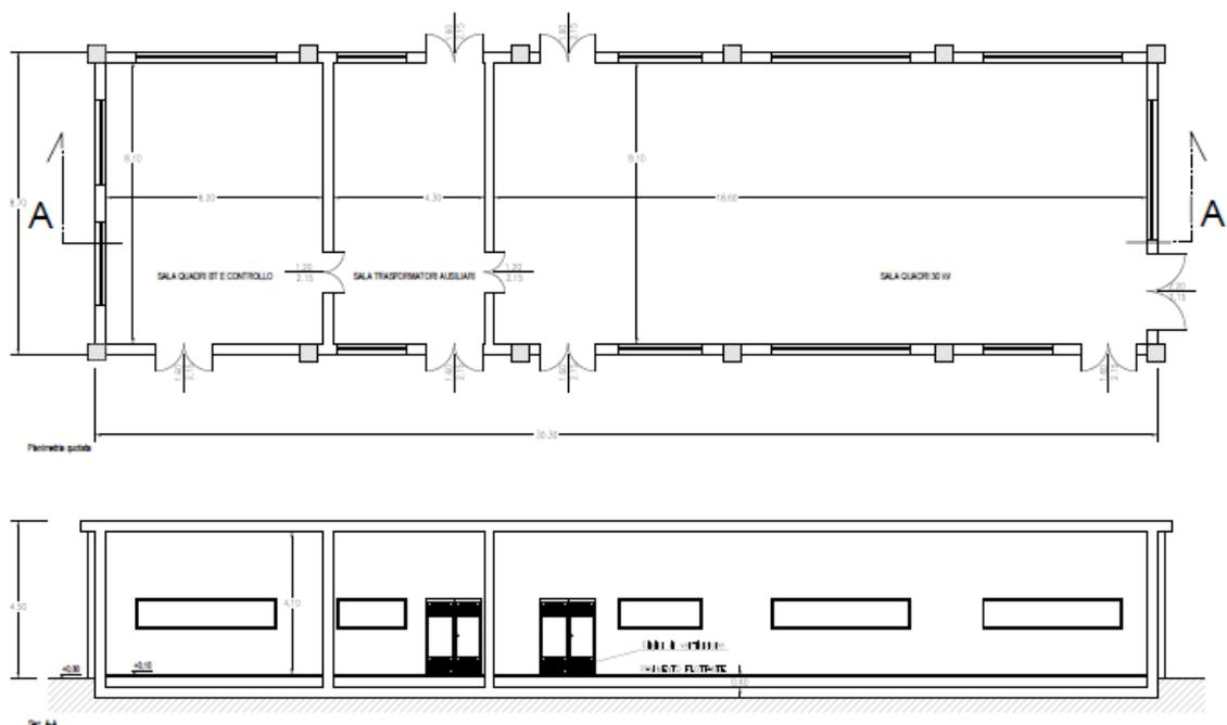
Figura 4-5: Viste in pianta e sezione cabina di smistamento
