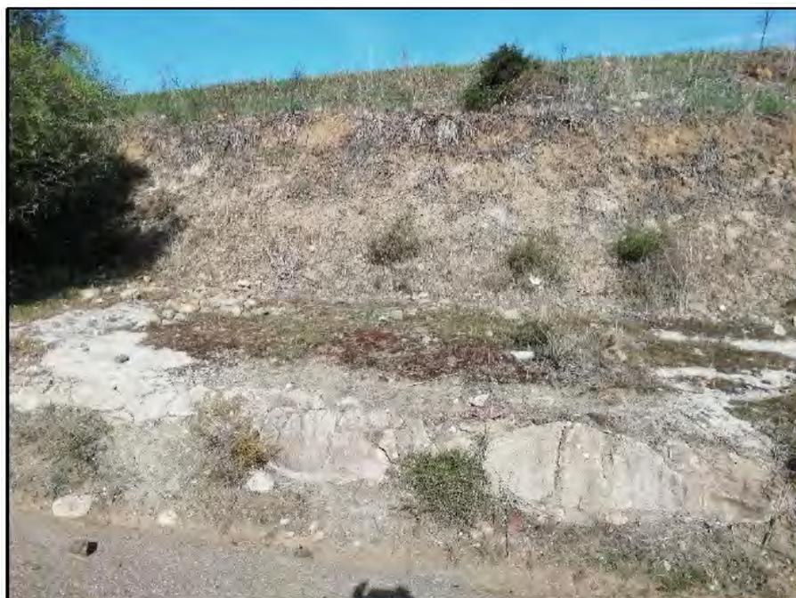
*Figura 6.29: Affioramento nell'area di studio della copertura alluvionale sopra delle arenarie della Formazione del Cixerri.*
