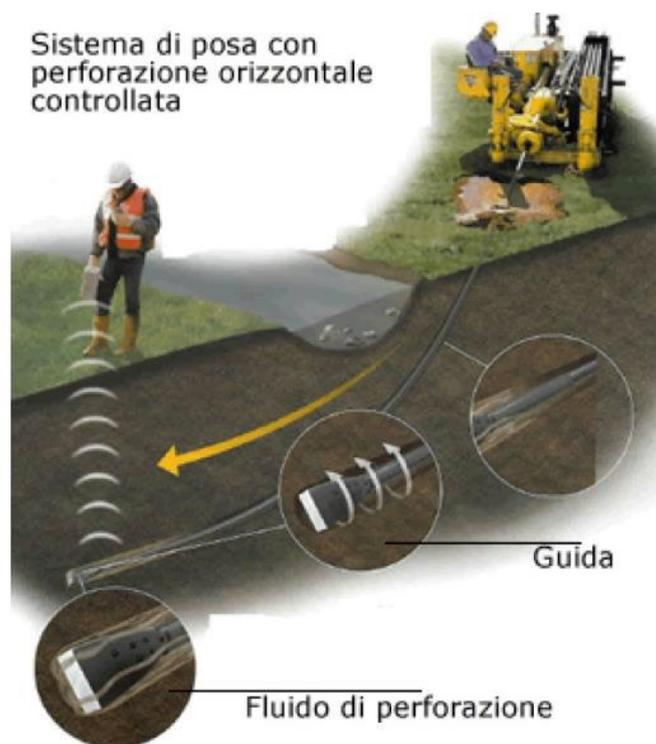
Sistema di trivellazione orizzontale controllata (T.O.C.).
