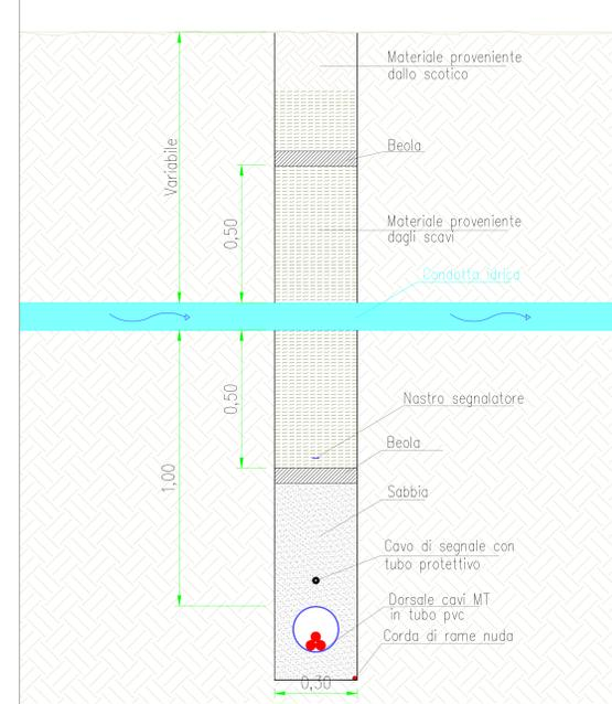
Risoluzione Int.09 - Sezione trasversale - Scala 1:10
