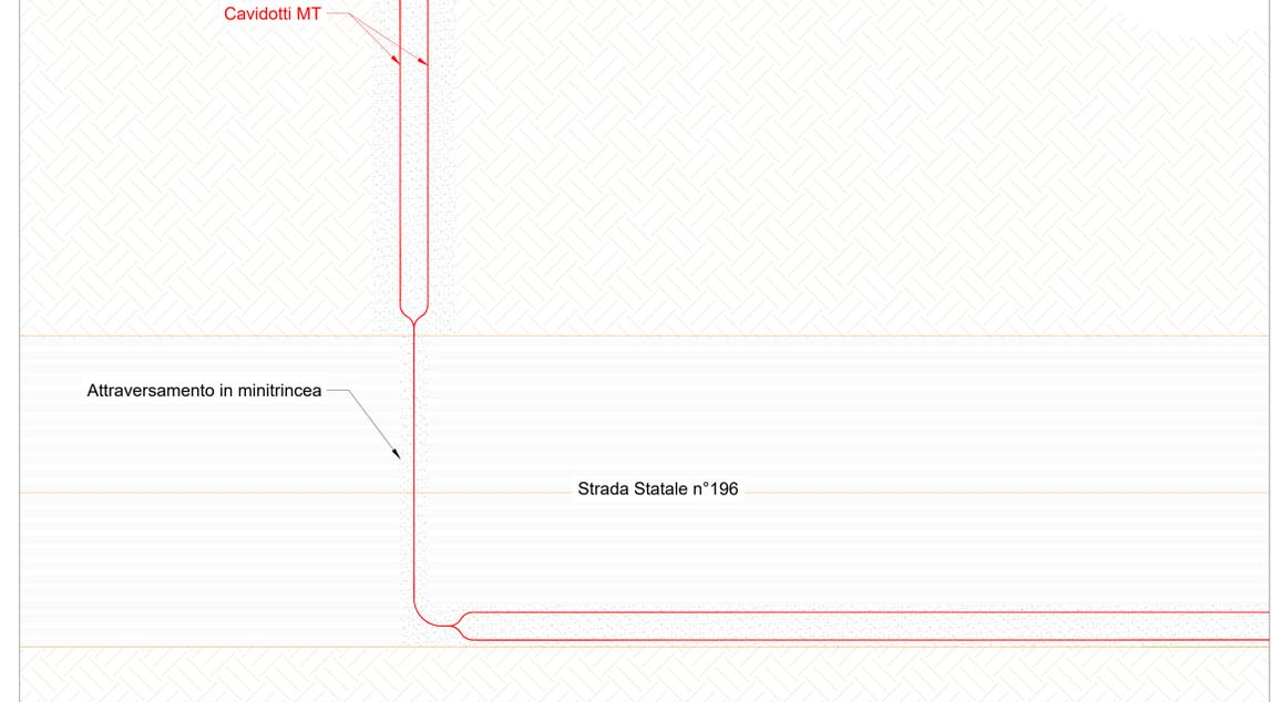
Risoluzione Int.15 - Sezione longitudinale - Scala 1:20
