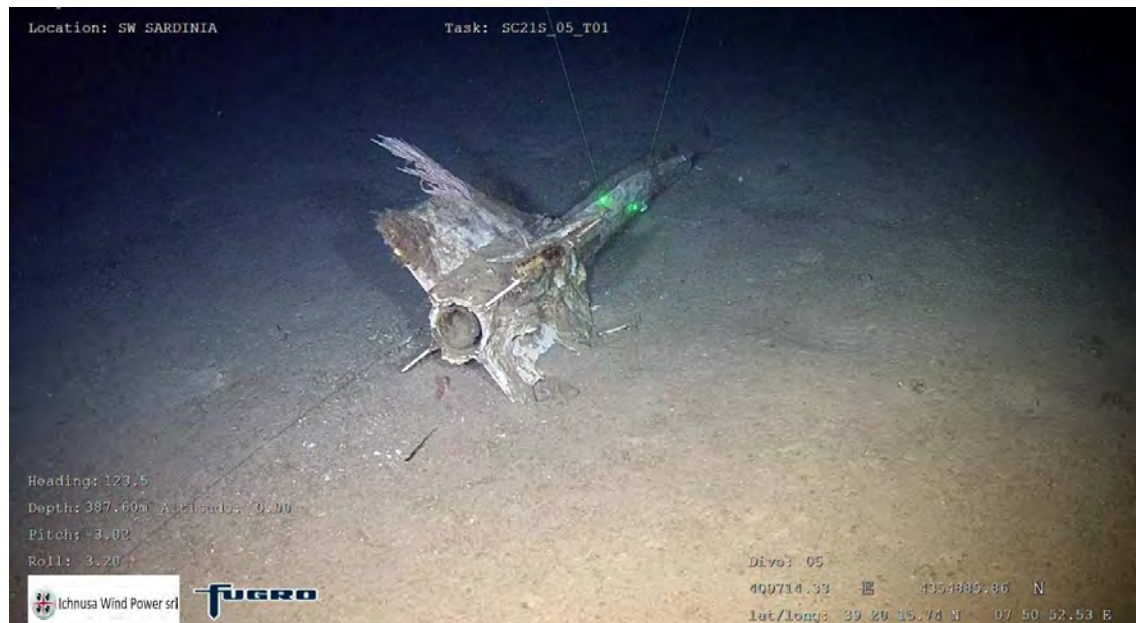
Figura 2.16: Parte inferiore di un AIM-9 Sidewinder (missile aria-aria) esploso- TA3.03 [SC21S_05_T01]
