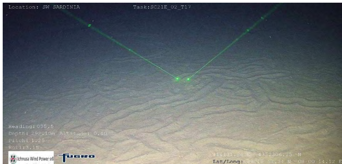
Figura 2.20: Sedimenti argillosi con forte presenza di bioturbazioni [SC21E_02_T17]
