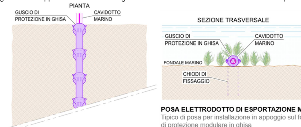
Figura 3.13 – Tipico di posa dell'elettrodotto marino con protezione in elementi tubolari modulari.
