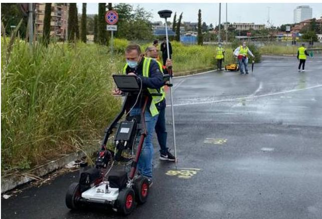
**Figura 6.2 – Operatore impegnato nell'acquisizione di un profilo georadar.**
