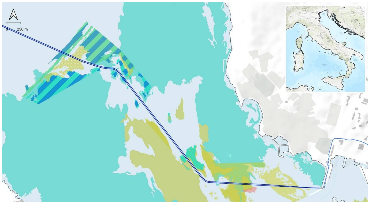
PARCO EOLICO FLOTTANTE NEL MARE DI SARDEGNA SUD OCCIDENTALE Tracciato dell'elettrodotto marino su mappatura Posidonia oceanica Elaborazione iLStudio
