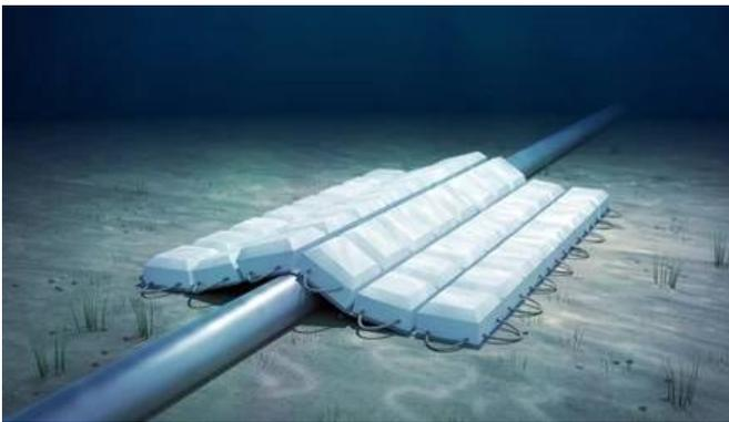
Figura 6.5 – Esempio di posa con protezione a materassi in cls (rendering).
