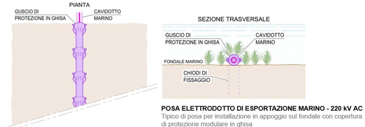
**Figura 6.6 – Tipico di posa dell'elettrodotto marino con protezione in elementi tubolari modulari.**
