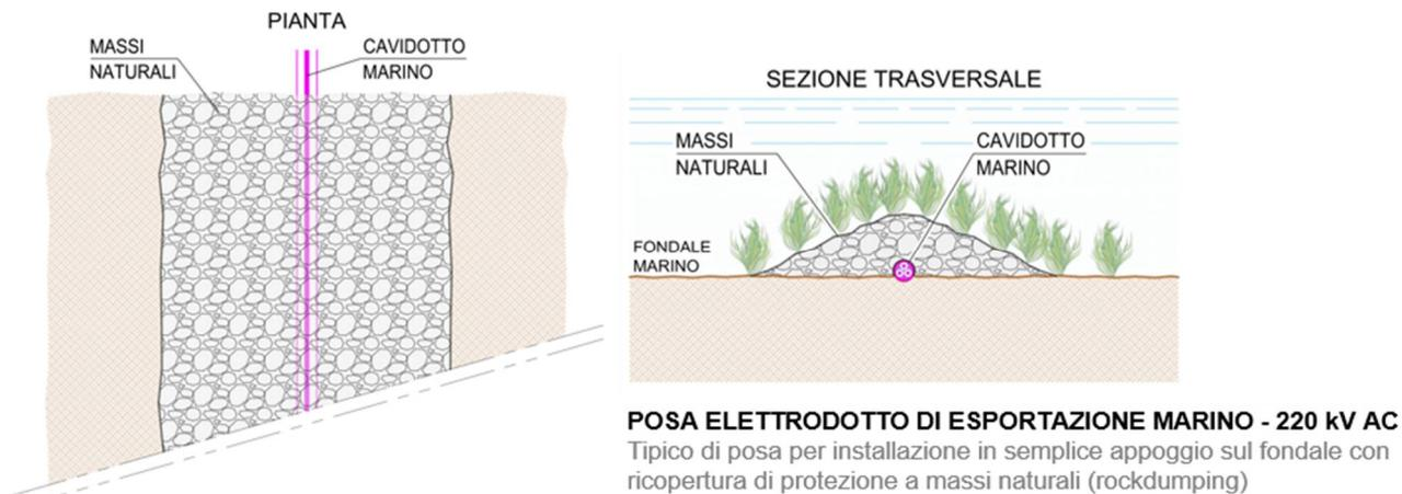
Figura 6.2 – Tipico di posa dell'elettrodotto marino con protezione in massi naturali.
