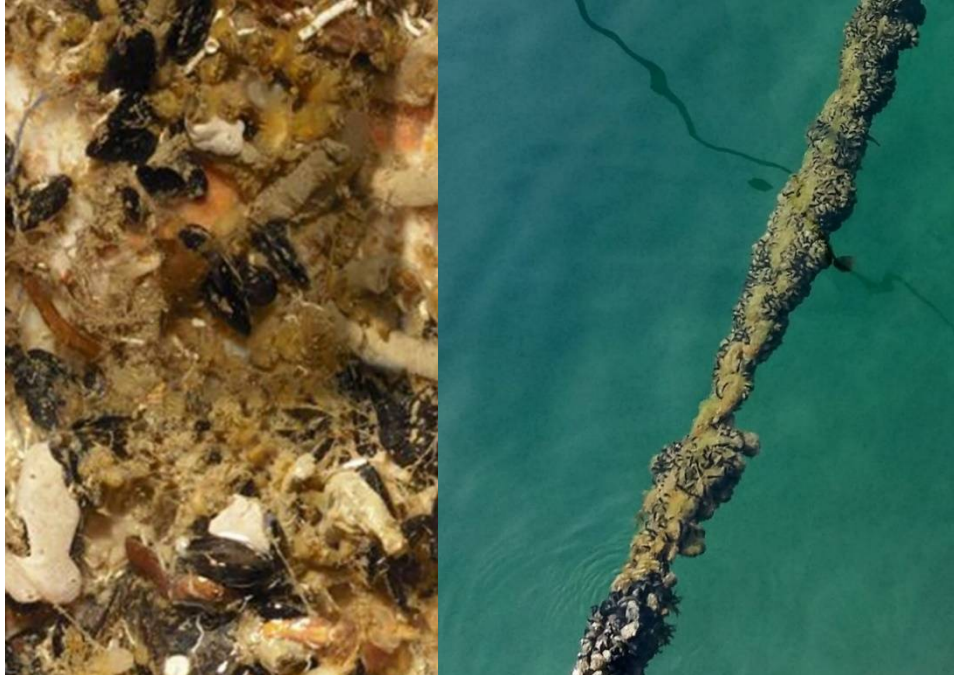
Figura 3.5 – Esempi di biofouling su elementi sommersi.
