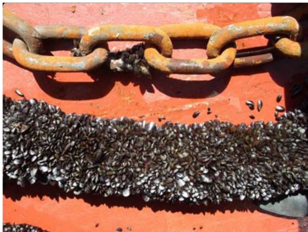
Figura 1.1 – Sezione di catenaria post manutenzione e sezione di catenaria colonizzata da biofouling.
