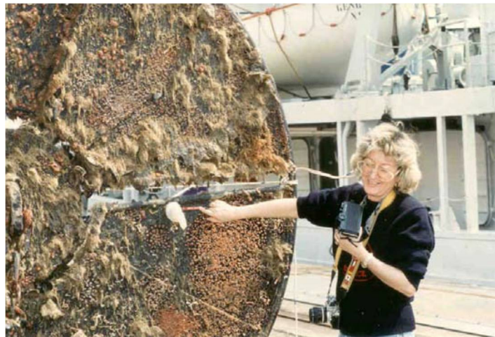
Figura 3.9 – Biocolonizzazione sulla faccia inferiore del disco di smorzamento.
