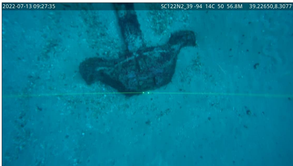
Figura 54. Il Target TA2: particolare del diamante e delle marre mobili ( Nextgeo )
