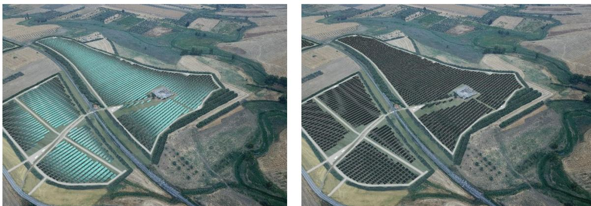
*Figura 20 - Rendering dell'impianto con moduli in silicio policristallino (foto a sinistra) e impianto con moduli con tecnologia antiriflesso in silicio monocristallino (foto a destra)*
