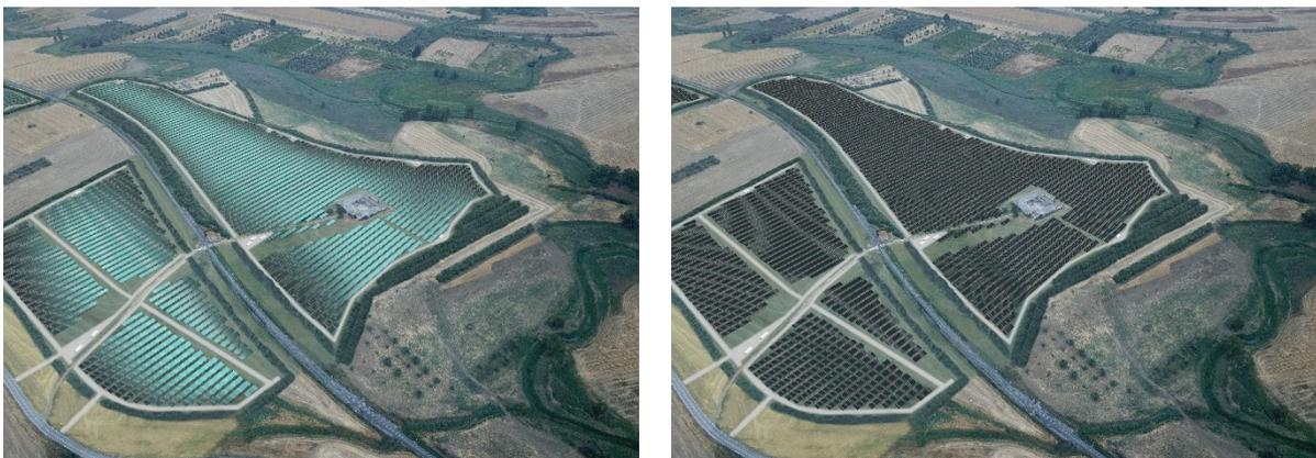
*Figura 35 - Rendering dell'impianto “VILLALBA II” con moduli in silicio policristallino (foto a sinistra) e con moduli con tecnologia antiriflesso in silicio monocristallino (soluzione adottata – foto a destra)*
