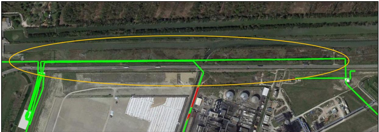
**Figura 28** – Stralcio immagine satellitare– cerchiata in arancione l'area interessata (in rosso metanodotto In progetto, in verde tratti in dismissione)
