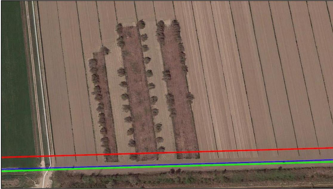
**Figura 8** – Stralcio immagine satellitare marzo 2020 (in rosso metanodotto In progetto, in verde tratti in dismissione, in blu esistente)
