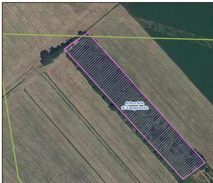
**Figura 36** – Stralcio dal SIF dell'area in origine classificata come Arbusteto di Sanguinello (in rosso metanodotto In progetto, in verde tratti in dismissione)
