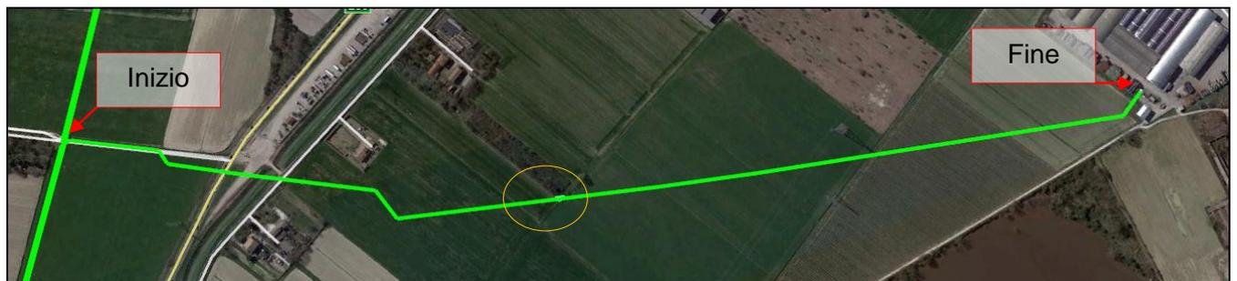
**Figura 35** – Stralcio immagine satellitare con indicazione dell'area originariamente classificata nel SIF (in rosso metanodotto In progetto, in verde tratti in dismissione)
