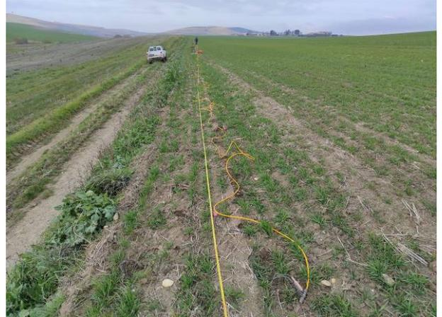
BS01 e MASW 01, particolare della strumentazione
