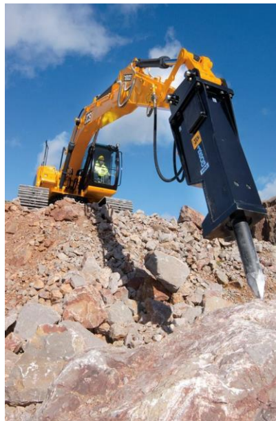
Escavatore con martello demolitore
