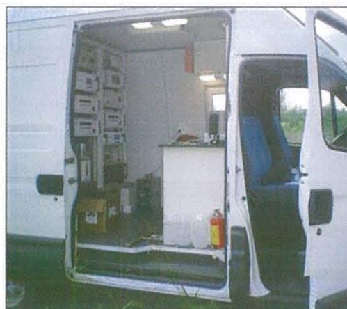
Figura 2-3: Monitoraggio qualità dell'aria mediante stazione mobile.
