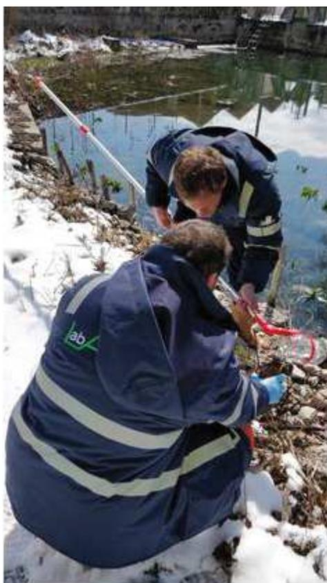
**Figura 15: Prelievo campioni d'acqua con asta telescopica effettuati presso la sorgente Peschiera Pedale**
