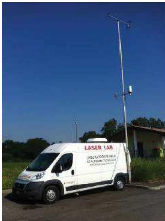
**Figura 2: Stazione mobile utilizzata per il monitoraggio della qualità dell'aria**
