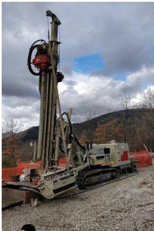
**Figura 11: Sonde idrauliche utilizzate per la realizzazione dei sondaggi profondi**
