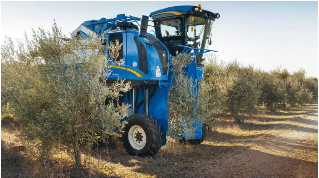
**Figura 20: Macchina per la raccolta delle Olive su impianto super intensivo e disposizione ideale degli alberi per il corretto impiego della stessa**
