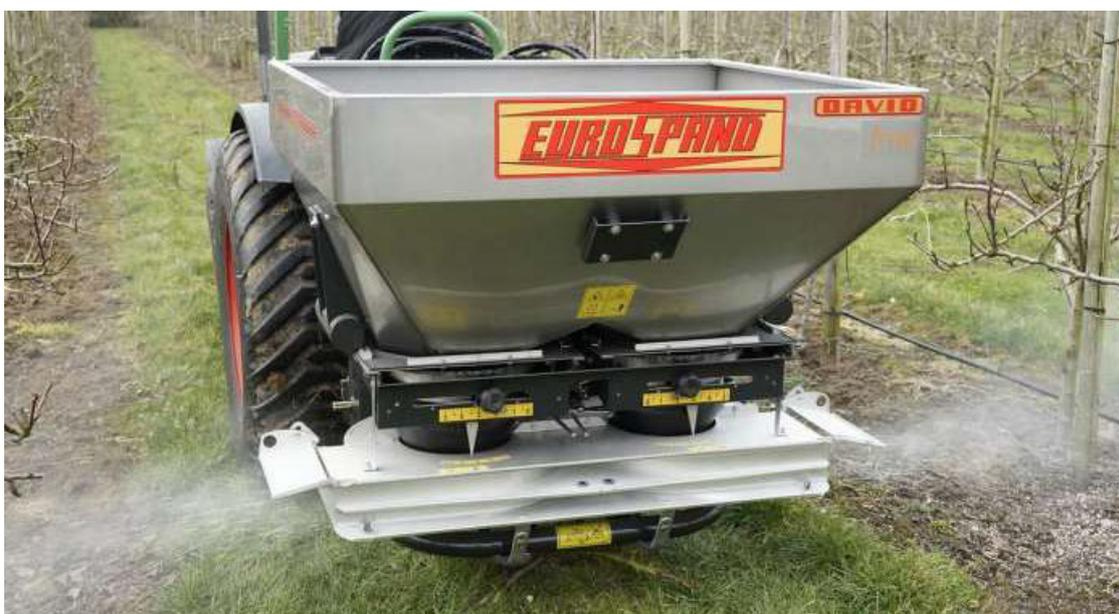
**Figura 22: Esempio di spandiconcime localizzato mono/bilaterale per frutteti**
