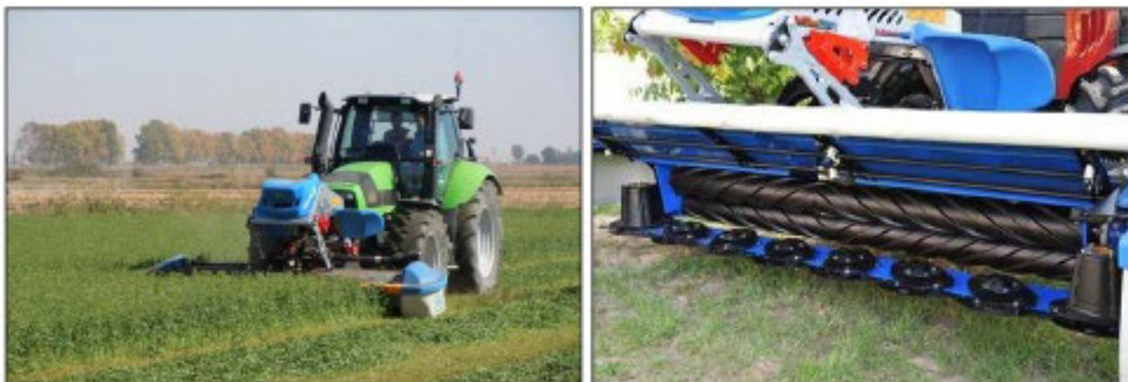
**Figura 10: Esempio di falciacondizionatrice frontale e particolare dei rulli in gomma**
