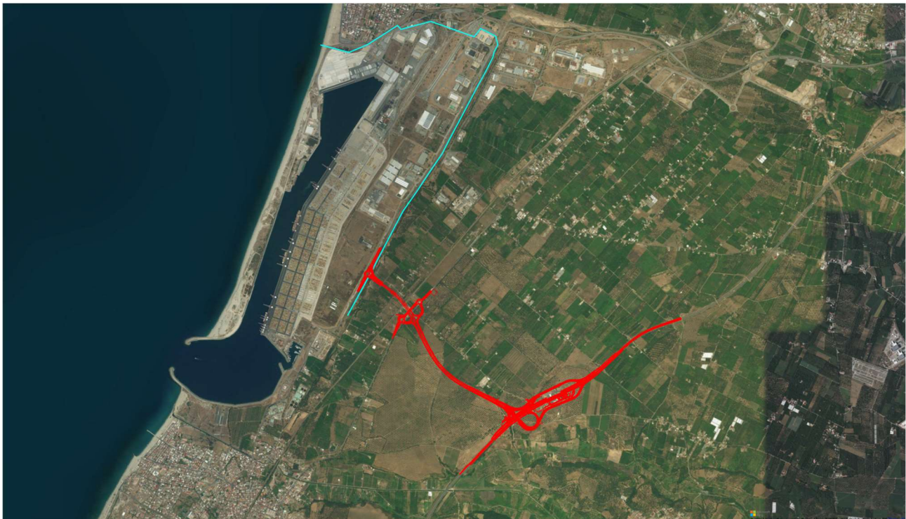
Figura 2 – Interferenza tracciato con il Canale IV
