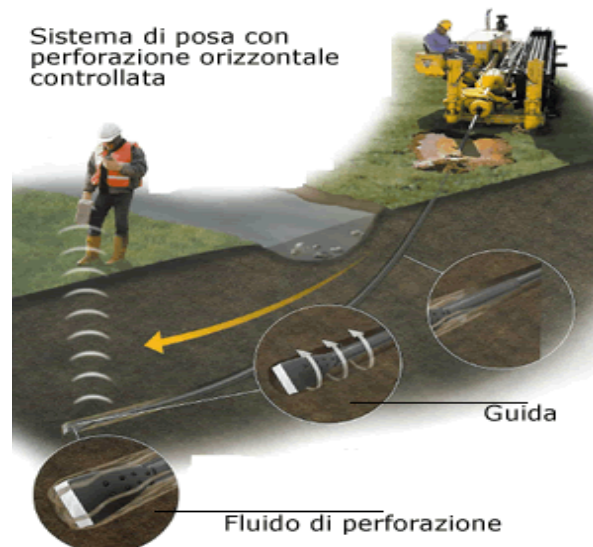
FIG 6 Sistema di trivellazione orizzontale controllata (T.O.C.).
