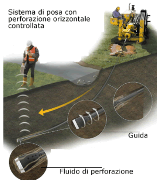
Figura 2-10: Sistema di trivellazione orizzontale controllata (T.O.C.).
