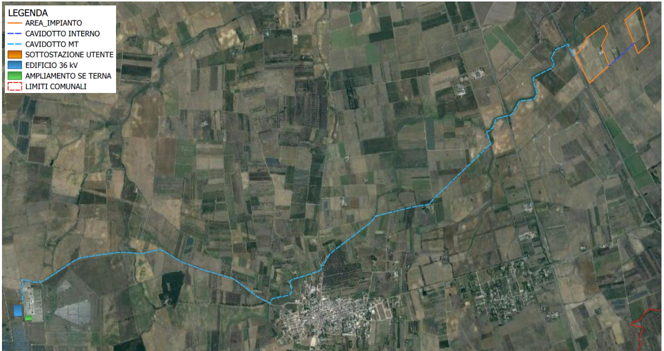
Figura 2-3: Inquadramento territoriale su Ortofoto del complesso del percorso del cavidotto di connessione MT (in azzurro)
