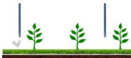
Figura 25. Sistema agrivoltaico in cui i moduli fotovoltaici sono disposti verticalmente. La coltivazione avviene tra le file dei moduli fotovoltaici, l'altezza minima dei moduli da terra influenza il possibile passaggio di animali
