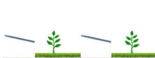
Figura 23. Sistema agrivoltaico in cui la coltivazione avviene tra le file dei moduli fotovoltaici, e non al di sotto di essi
