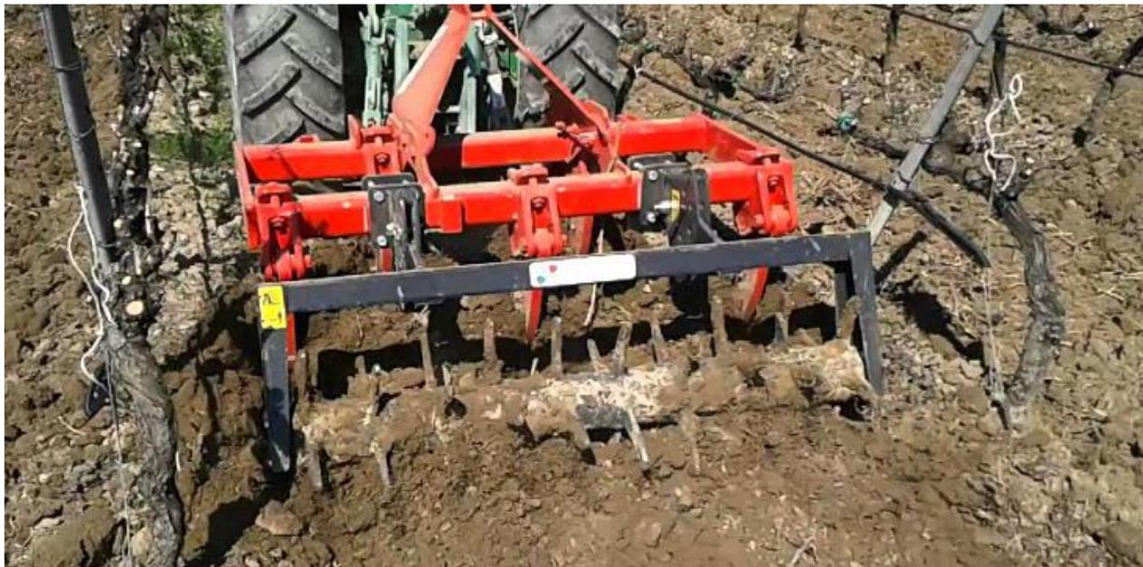
*Figura 38. Esempio di ripuntatore interfilare su trattore gommato.*
