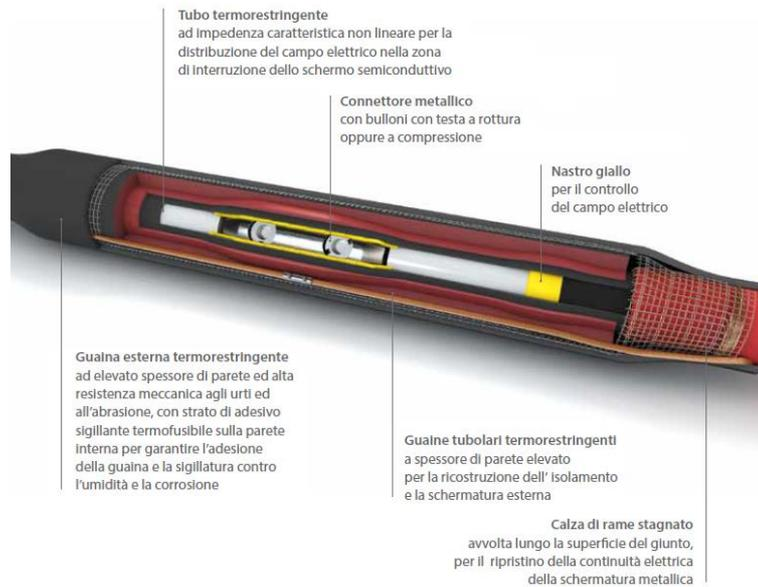
Figura 15. Esempio di giunto per cavo a 36 kV
