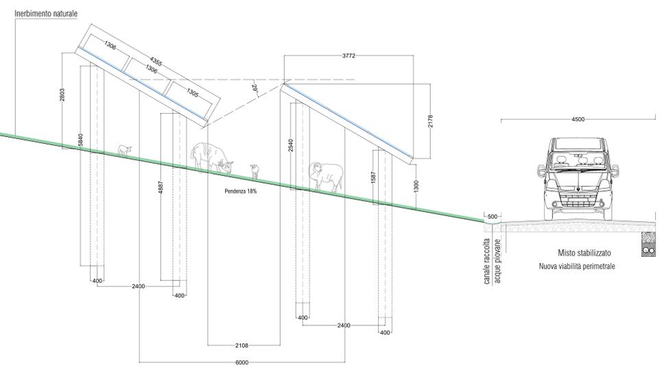
**Pianta e Sezione longitudinale strutture a telaio fisso**
